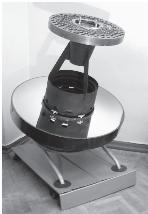
Рис. 8. Объектив космического телескопа с металлическими зеркалами из бериллия (главное зеркало диаметром 1 м), разработанный в ГОИ.
