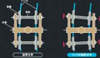
【曲線通過時の車輪の揺籠】
