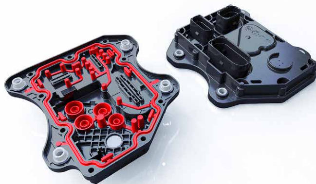
Mehrkomponentengehäuse aus Thermoplastik mit angespritzter Dichtung aus Flüssigsilikonkautschuk für ein elektronisches Steuergerät im Fahrzeug.
