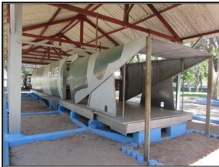
Figura 32 – Área de estágios (falso avião). Vista do “falso avião”, um equipamento utilizado para o treinamento da técnica aeroterrestre. Fonte: < http://www.cipqdt.eb.mil.br/ >.
