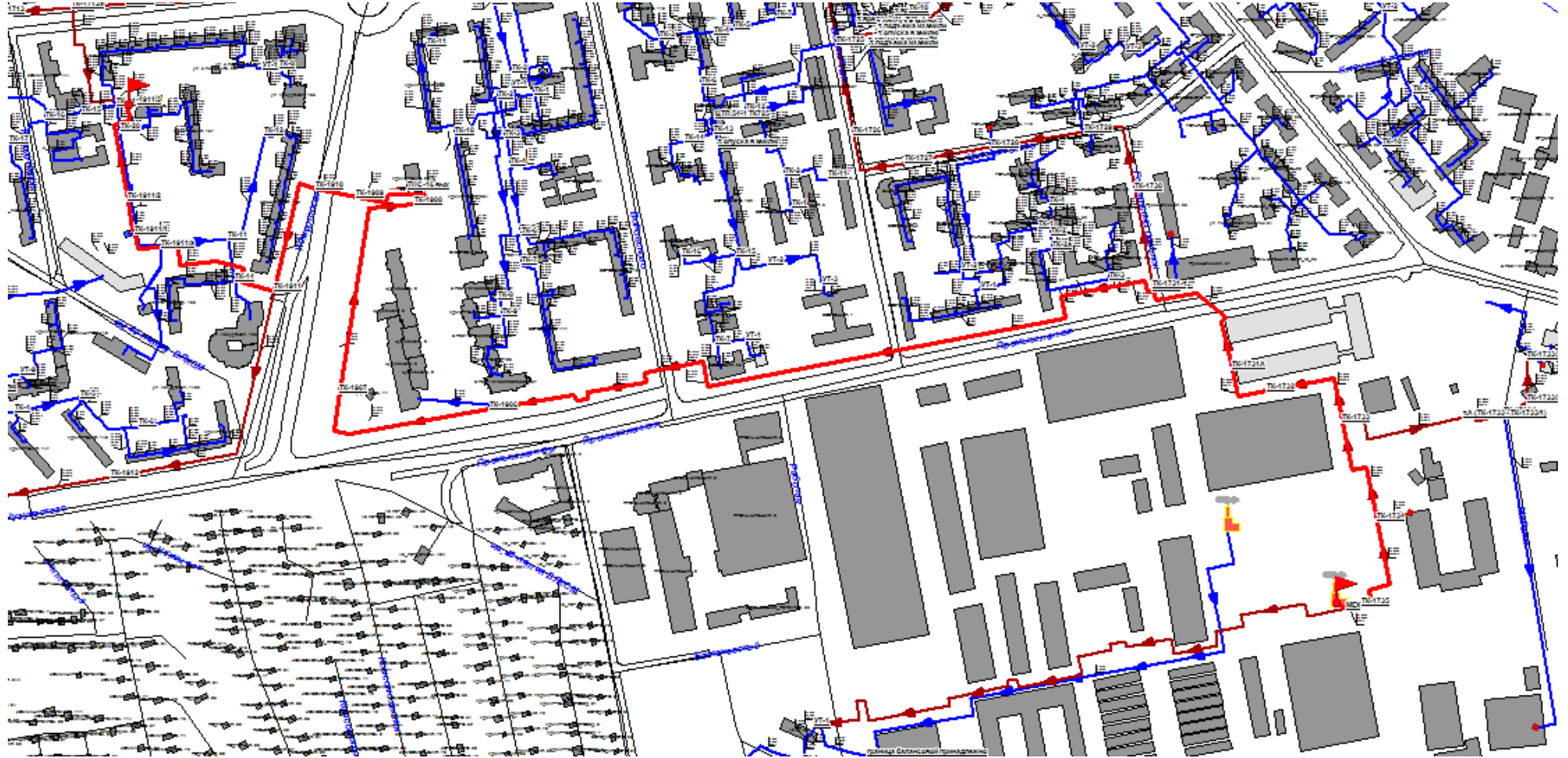
Рис. 3.8.24. Расчетная схема участка тепловой сети от котельной АО «ИМЗ» до ТК-1911/3
