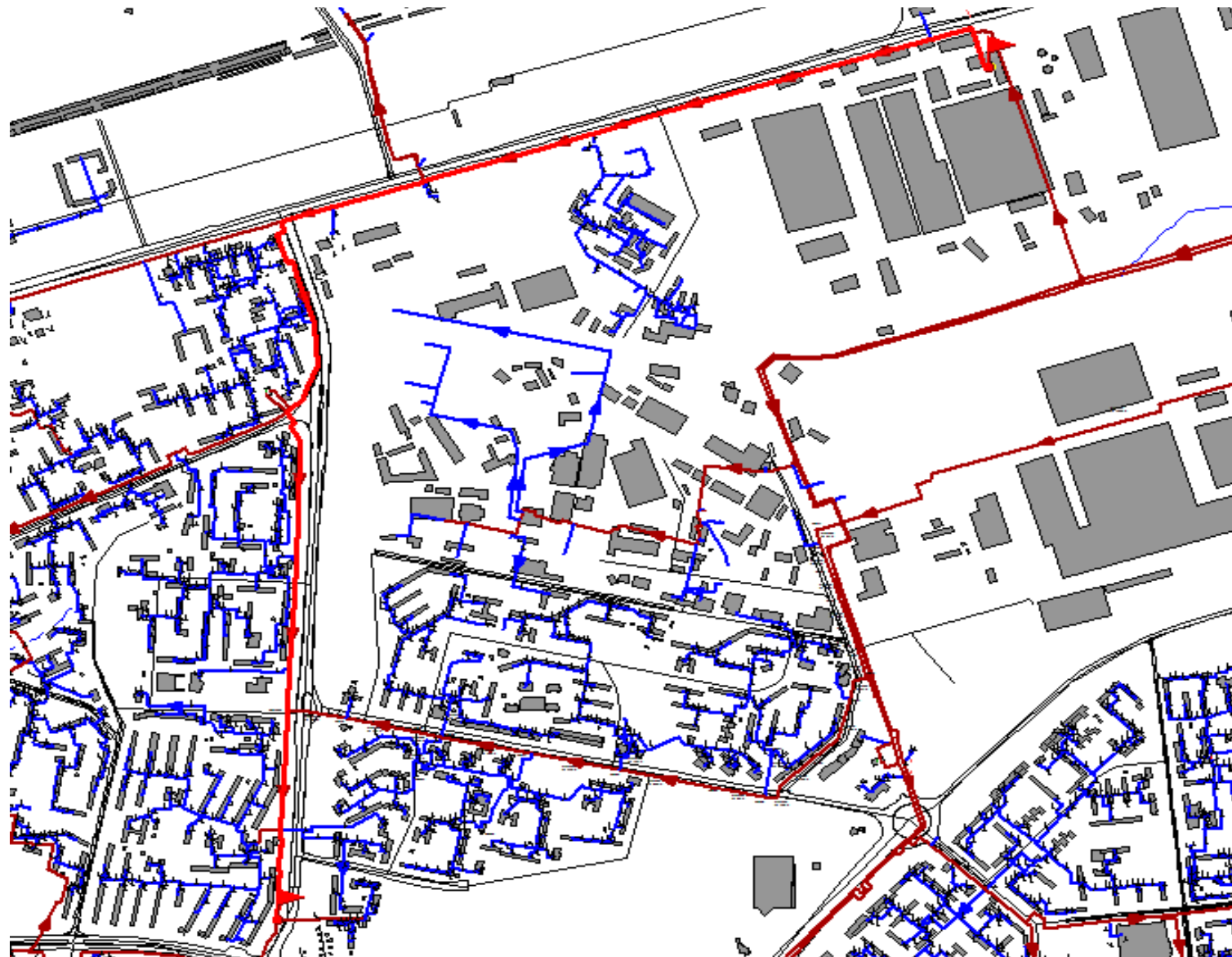
Рис. 3.8.14. Расчетная схема участка тепловой сети от котельной ОАО «Ижметмаш» до ТК-2309
