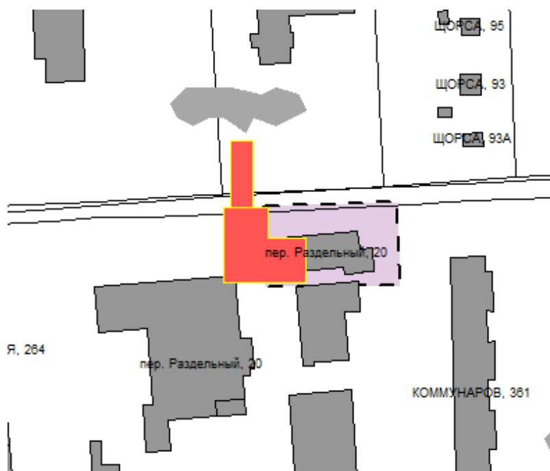
Рис. 4.3.32. Зона действия газовой котельной ул. Раздельный, 20
