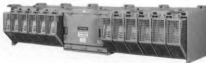
図2. VVVFインバータ 日本国内で使用されている標準型VVVFインバータとほぼ同じ仕様。
