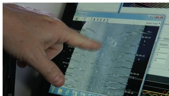
Fig. 16 En anomali er observert i multistråle ekkoloddet under Kartverket sjødivisjonens
