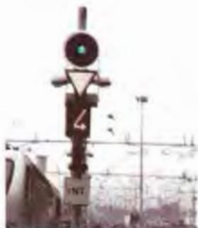
5. Sulle linee esercitate con il blocco elettrico i segnali di 1<sup>a</sup> categoria semplici o multipli di protezione e/o di partenza delle stazioni dotate di doppio segnalamento, di protezione dei posti di comunicazione e di protezione dei bivi, quando presentino un'indicazione di via libera con conferma di riduzione di velocità, possono essere integrati da una segnalazione ausiliaria che precisa il limite di velocità da rispettare. Tale segnalazione è costituita da:
