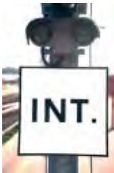
4. I segnali di 1<sup>a</sup> categoria semplici, e multipli quando il numero delle luci od ali sia inferiore a quello delle direzioni, sia luminosi che semaforici, possono essere integrati con indicatori di direzione costituiti da quadri che, a mezzo di numeri luminosi, indicano la direzione di inoltro (1).
