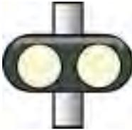
1. Il segnale di «avanzamento» è costituito da due fanali speciali abbinati orizzontalmente. I fanali del segnale di avanzamento sono normalmente spenti (inattivi); quando vengono accesi (cioè resi attivi) proiettano verso il treno due luci bianche lattee fisse o lampeggianti.
