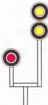
Via libera sul corretto tracciato. Preavvisa inoltre un successivo segnale a via impedita od un successivo segnale d'arresto a distanza anormalmente ridotta o su un binario di limitata lunghezza o parzialmente ingombro.
