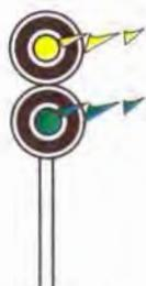
Via libera. Preavvisa inoltre un successivo segnale a via libera per un itinerario da percorrersi a velocità non superiore a 60 km/h.
