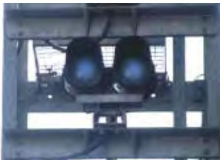
**9.** Il segnale ripetitore di partenza ha la funzione, quando disposto a via libera, di ripetere (con aspetto più restrittivo o equivalente) la disposizione a via libera del successivo segnale di 1<sup>a</sup>
