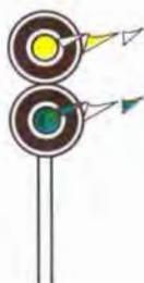
Via libera. Preavvisa inoltre un successivo segnale a via libera per un itinerario da percorrersi a velocità non superiore a 100 km/h.
