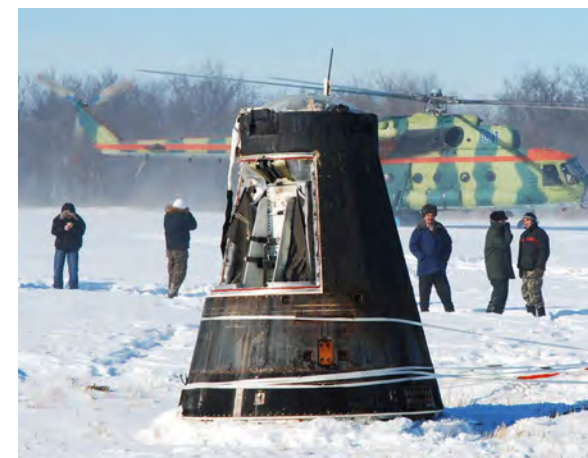
Рисунок 1.6. Спускаемый аппарат КА «Янтарь-2К» на месте приземления
