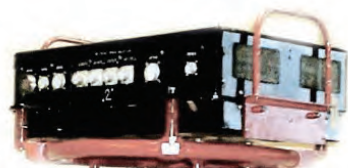
Блок электроники (150x306x474 мм)
