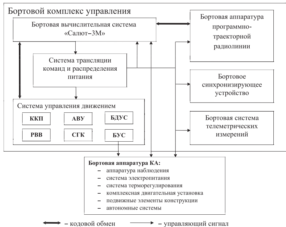
Рисунок 4.2. Структурная схема бортового комплекса управления КА «Янтарь»
