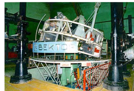
Рисунок 5.6. Динамический стенд на воздушной подушке «Вектор»
