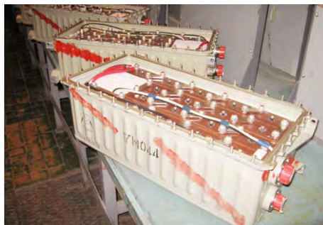
Рисунок 8.9. Блок на основе серебряно-цинковых аккумуляторов
