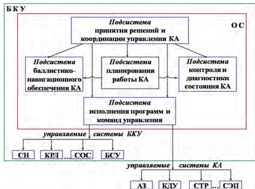
Рисунок 4.5. Функциональная схема БКУ
