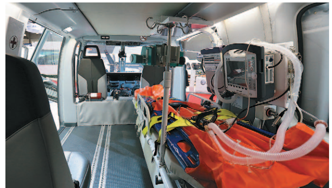
Рис. 7.5. Компоновка медицинского варианта
