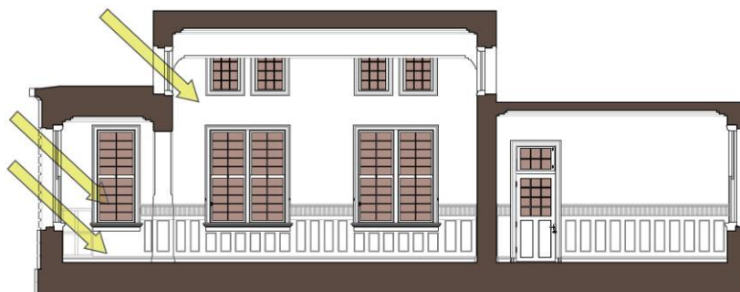
圖 3-220 原始[R03]西向採光方式
