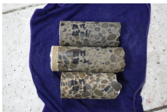
圖 5-50 鑽心取樣試體
