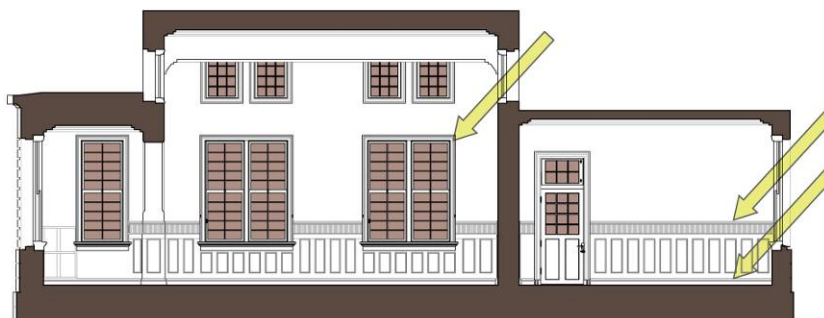
圖 3-221 原始[R03]東向採光方式
