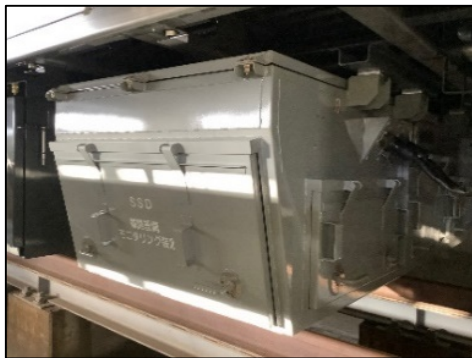
線路設備状態監視 (写真:房総・鹿島エリアE131系)
