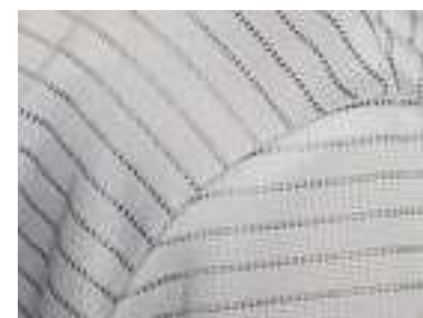
Antistatické a antibakteriální tričko vyrobené z materiálu obsahující stříbrem metalizovaná vlákna
