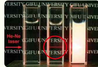
左：水 中央：チタンを含む無色透明溶液 右：二酸化チタンゾル
