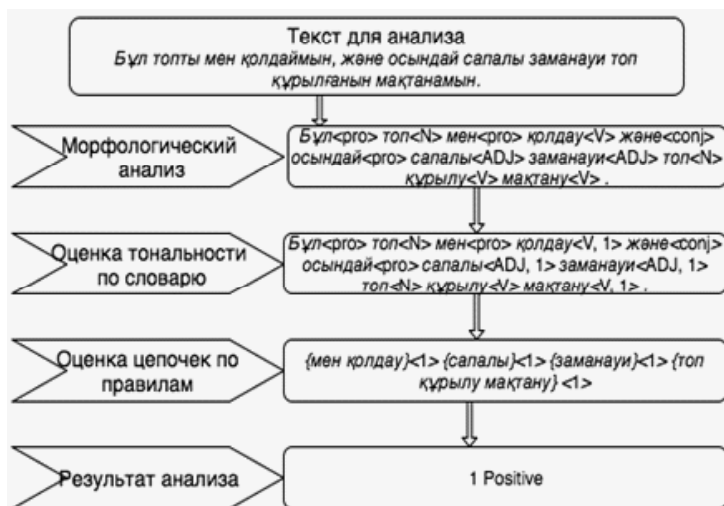
Рис. 2. Алгоритм определения сентимента текстов
