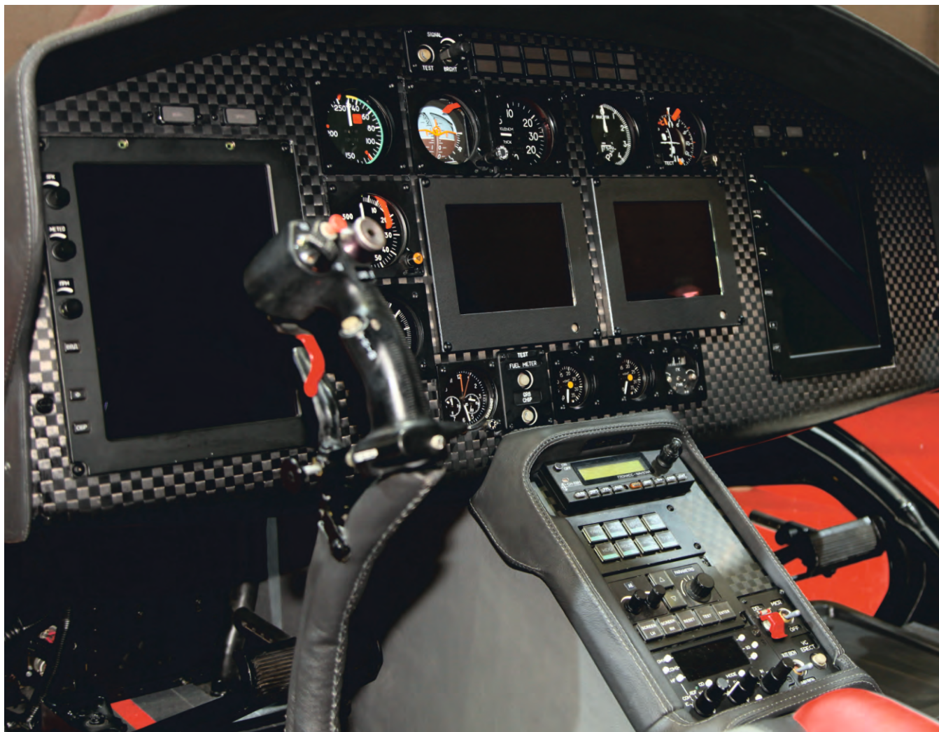
Рис. 4.1. Приборная доска и центральный пульт вертолета.
