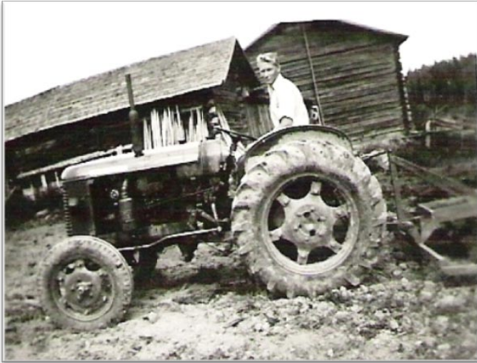
Erkki Kurkinen 1950-luvulla muokkaamassa lapiorullaäkeellä. Vetokoneena David Brown-petrolitraktori, vm. 1953.
