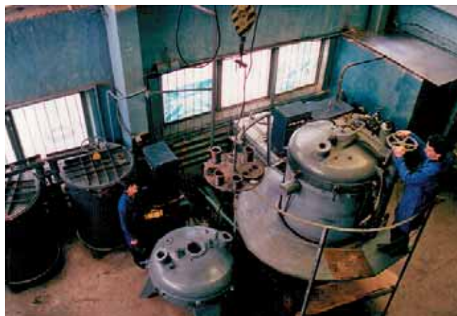
Промислова установка для іонного безводневого азотування, розроблена і виготовлена в ПНФТЦ
