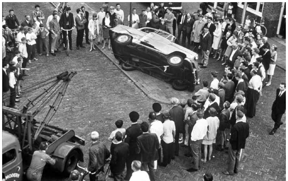
afbeelding 11 De Holmes kraan op de International KB2 was volledig handbediend. Vooral bergingen binnen de bebouwde kom trokken zonder uitzondering veel publiek, zoals hier in 1967.
