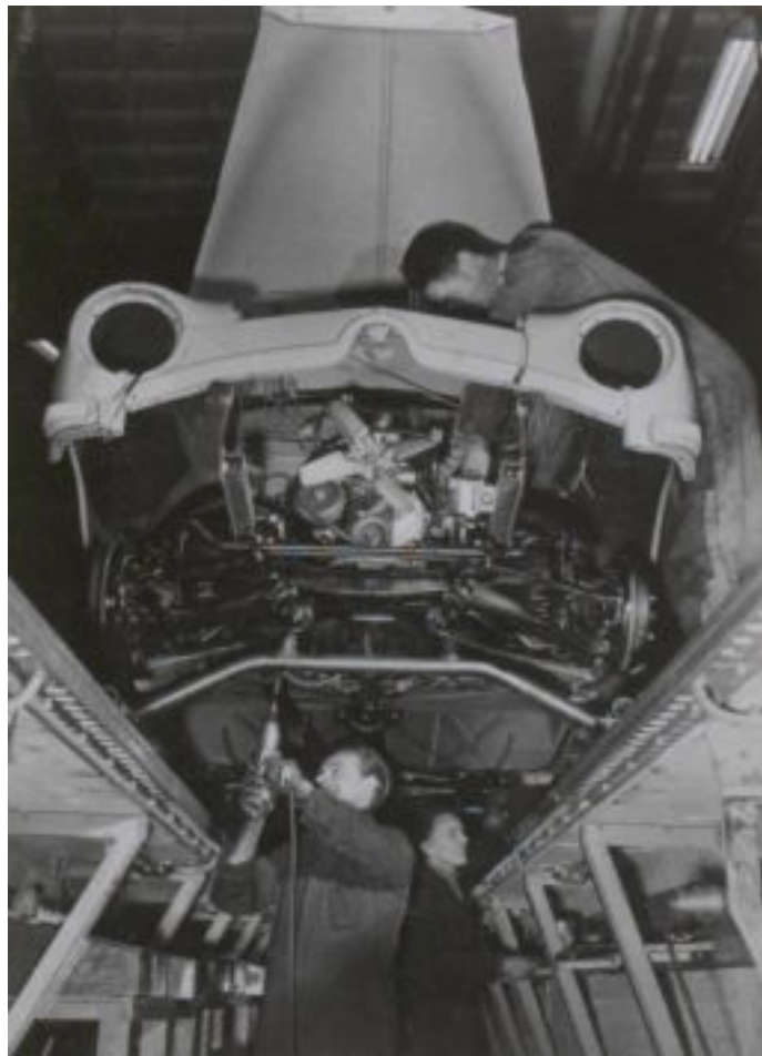
Foto 10. Het onderaanzicht van de Simca Aronde op de produktielijn bij de NEKAF (Bron: Coll Jac Maurer/ Photothèque Renault France).
