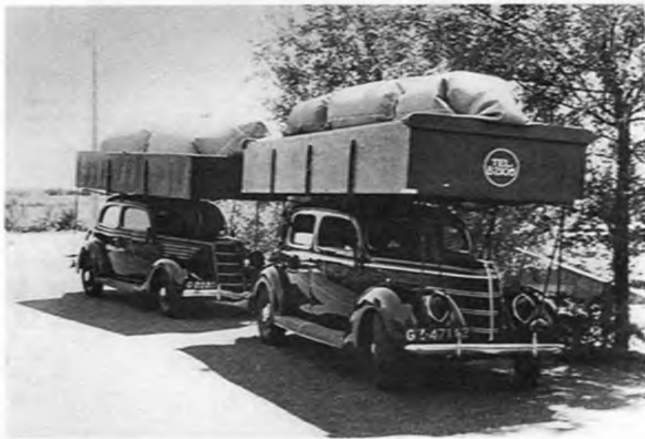
Twee Amerikaanse Fords, bouwjaar 1939 en 1935, staan in de oorlogsjaren bij Garage Dunnebiel in Assendelft. De auto's zijn uitgerust met een reservoir voor stadsgas. (Foto: collectie familie Wilderom Assendelft, coll. Eduard Hattuma)
