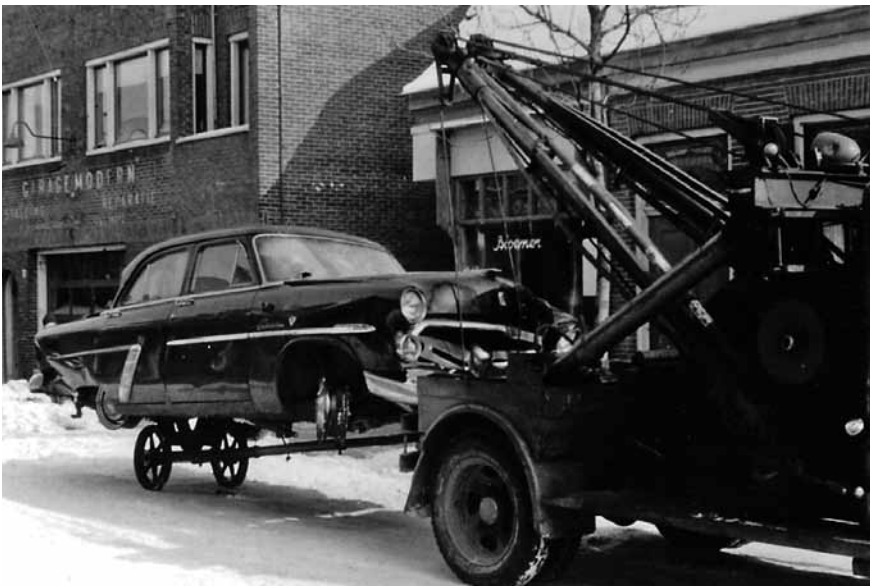
afbeelding 6 Begin jaren vijftig nam men het tijdens bergingstransporten met de veiligheid nog niet zo nauw. Een dolly met massieve banden maakte het mogelijk om deze zware Amerikaanse Ford met alle wielen vrij van de grond te vervoeren.
