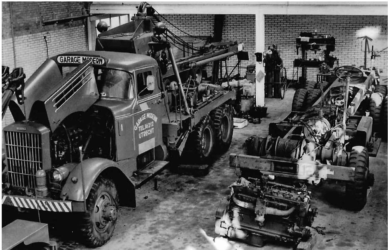
afbeelding 12 De White in deels onttakelde toestand, gereed om te worden verzwaard (1965). Links daarnaast staat een Federal 606 in onderhoud. De verhoogde toren en de bokkenpoten langs de giek zijn hier goed zichtbaar.
