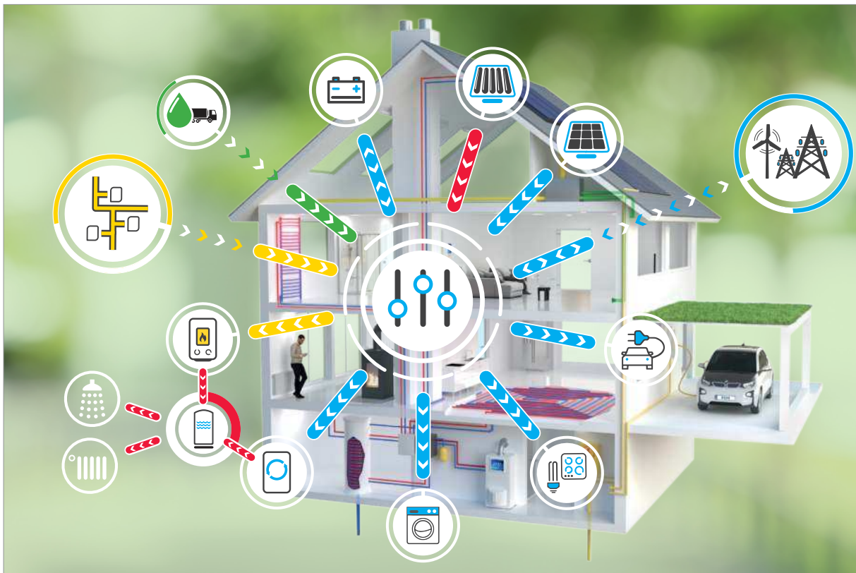
Figura 108. Conexión en red de productos relacionados con la energía con sistemas inteligentes de gestión de energía en el hogar (HEMS)
