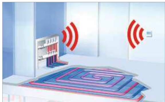
Figura 92. Control del distribuidor del circuito de calefacción a través de un control remoto.
