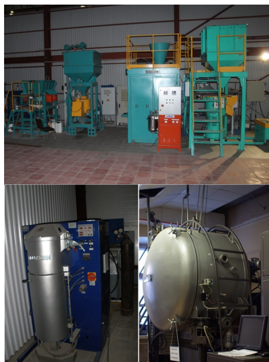
Рисунок 5.1. Основные производственные участки НПК кафедры ТЛП НИТУ «МИСиС»: а - плавильный; б - изготовления форм и стержней из ХТС; в - непрерывного литья слитков; г - вакуумной плавки и литья
