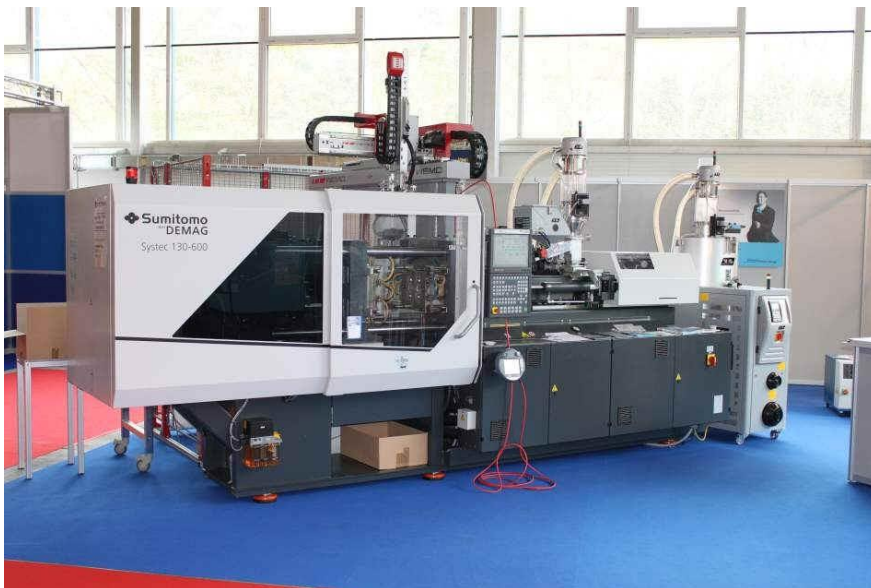
Slika 24: Sodobni električni stroj za brizganje plastike opremljen z robotom
