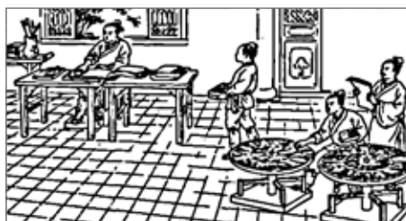
КИТАЙСКАЯ ТИПОГРАФИЯ С ВРАЩАЮЩИМИСЯ НАБОРНЫМИ КАССАМИ, ОК. 1300 г.
