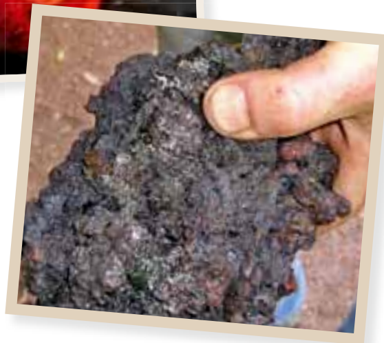
Охлажденная крица, ПРОПИТАННАЯ ШЛАКОМ
