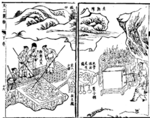
Ящичные мехи с водяным (наверху) и ручным (справа) приводом: верхняя – иллюстрация из энциклопедии Сун Инсина «Тянь гун кай у»; справа – иллюстрация из книги Ван Чжэня «Нун шу»
