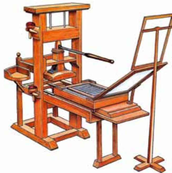
Процесс подготовки текста (сверху) и печатный пресс (снизу) Гуттенберга. Подготовка текста (слева направо): гравировка пуансона, подготовка матрицы, отливка литер в ящике с подвижными стенками, набор текста с помощью наборного ящика
