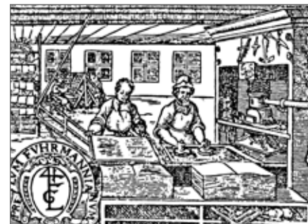
Нанесение краски на наборную форму с под- готовленным текстом
