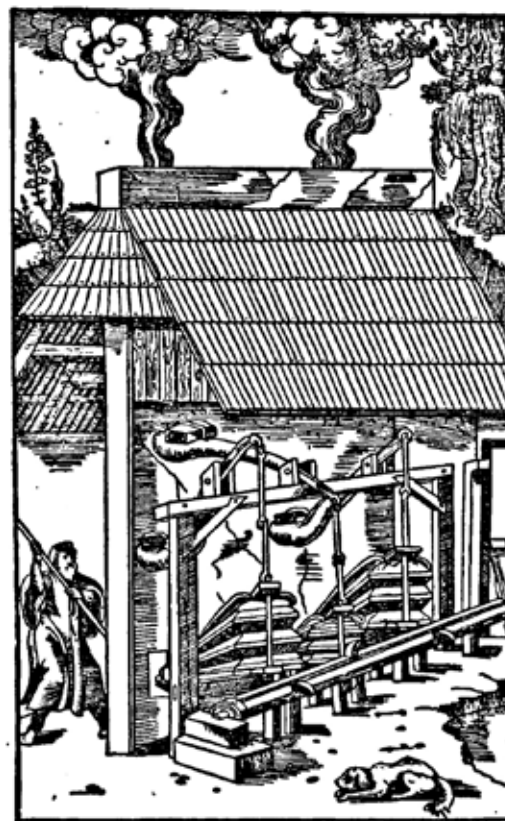
Мехи, расположенные с задней стороны заводской стены. Гравюра из труда Георгия Агриколы «12 книг о металлах»
