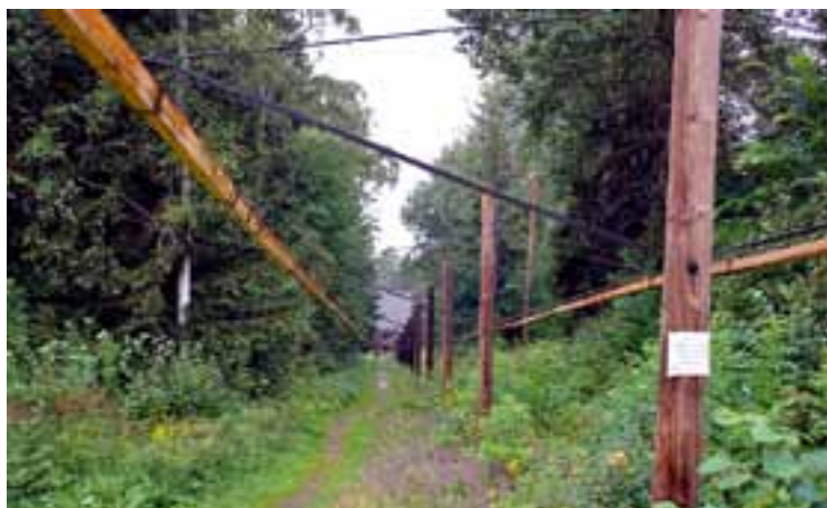
Привод от водяного колеса к водяному насосу конструкции К. Полхема
