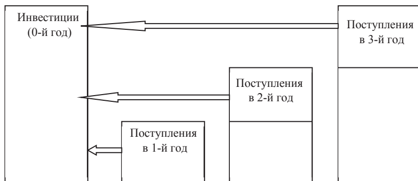
Рис. 3.7. Схема определения срока окупаемости проекта
