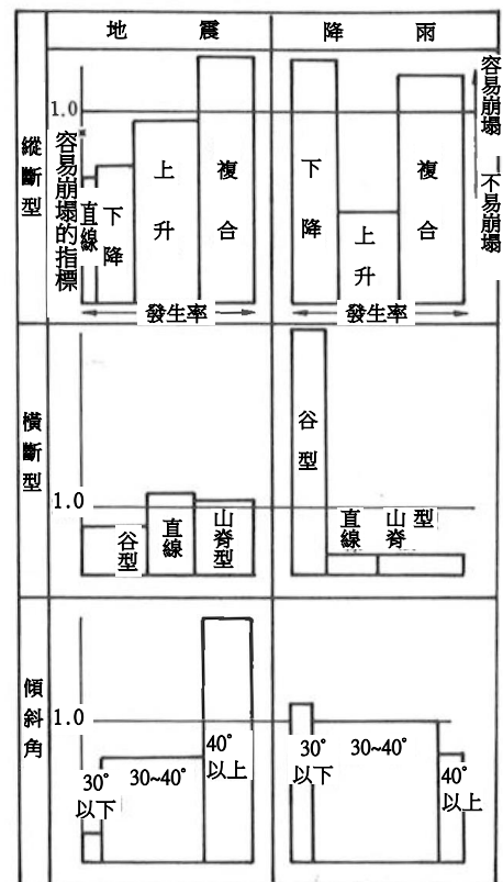
圖 6.25 山腹地形與崩塌 7)
