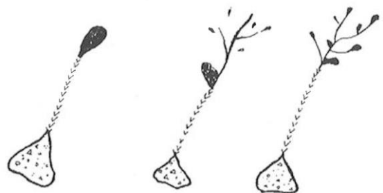
圖 6.78 土石流發生型態模式圖
