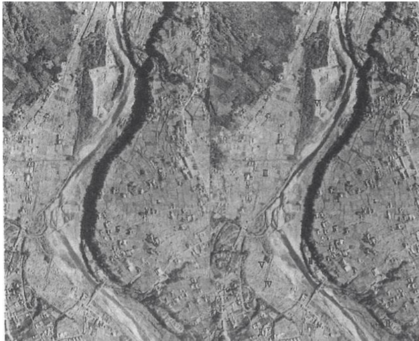
圖 5.2 河岸階地判釋例子：由高往低依序是 I、II、III、IV、V、VI，越高的形成年代越久遠。目前會受到洪水影響的為 IV～VI 的階地面。－立體照片－
