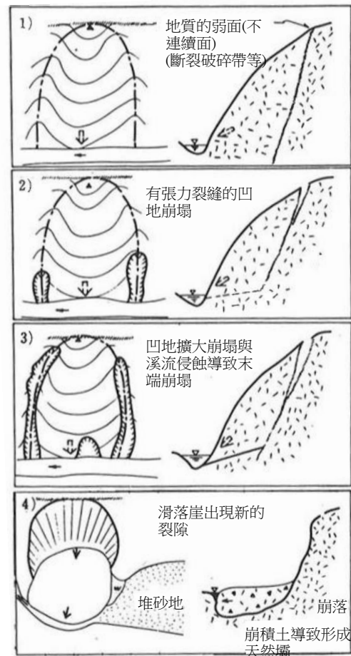
圖 6.72 裂隙地形的發展過程 (足立原圖) 17)
