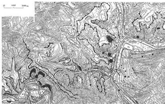
圖 6.30 豪雨型崩塌多出現在遷急線下方 (原圖)
