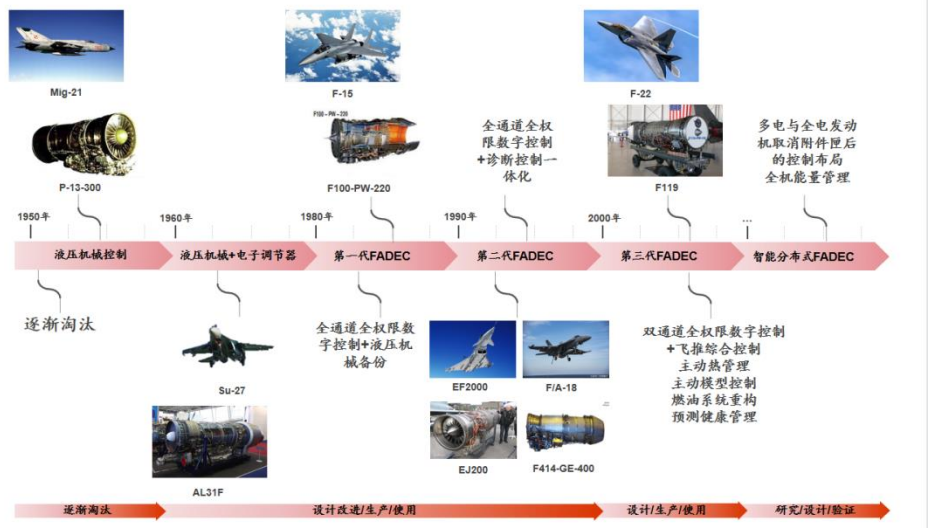
图表 22：航空发动机控制系统发展历程
