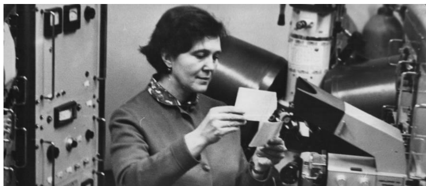
Геологический институт КФАН СССР. Кандидат технических наук Л. И. Полежаева у электронного микроанализатора за определением количественного состава вещества. 1974 г. ГОКУ ГАМО в г. Кировске. Ф. Р-19. Оп. 2. Д. 1640.
