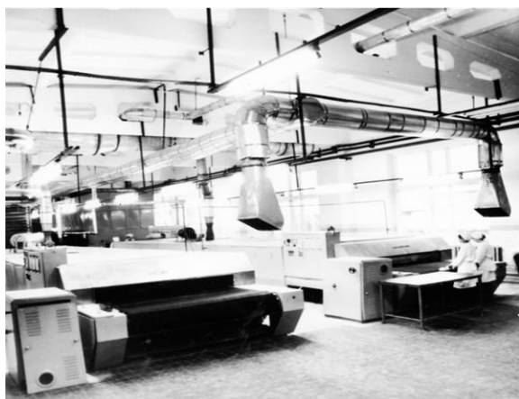
Поточная линия хлебопечения Апатитского хлебопекарного объединения ГОКУ ГАМО в г. Кировске. Ф. Р-19. Оп. 4. Д. 399.
