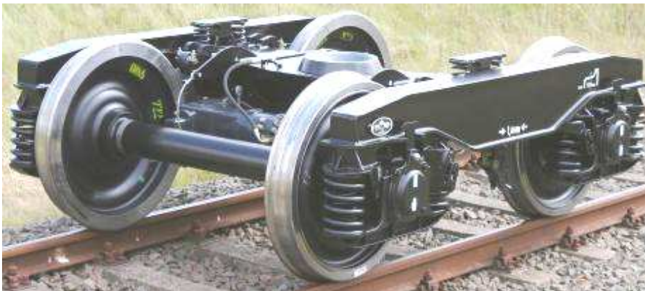
Y25Lsi-C – Y25 mit Kompaktbremse
