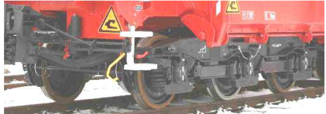
ELH3-25 – Schwerlastdrehgestell für 25 t RSL
