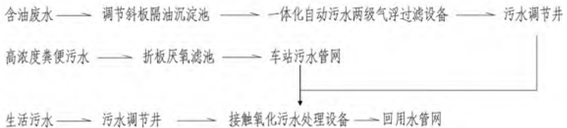
图 4.4-11 南沙港站污水回用流程图
