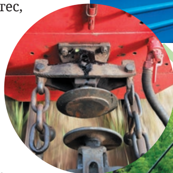
Зчіпка на крючках з'єднує електровоз і спеціальні вагони. Грузи висять, щоб не злітало.
