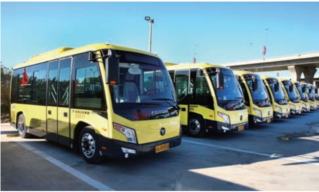
■ 6米纯电动微循环车 北京最短的公交车，灵活便利、清洁环保，用于社区微循环线路，解决小区居民出行“最后一公里”出行问题。
