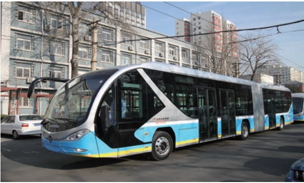
■ 18米双源无轨电车 北京最长的双源无轨电车，因车头的弧线设计被称为“电鲛鱼”，应用于BRT3线。
