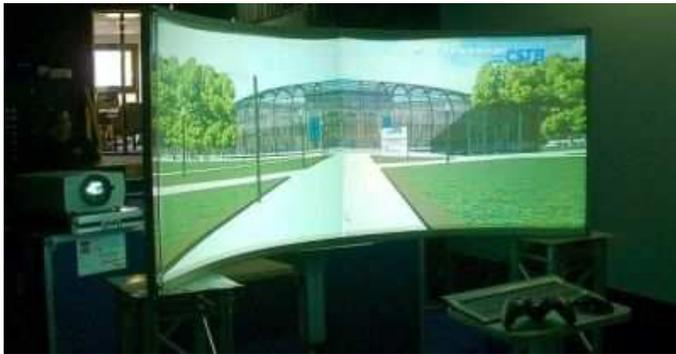
**Figure 5 Un écran conique permettant de projeter une image d'environ 33 m<sup>2</sup>.**
