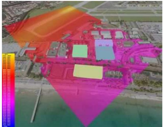
Figure 18 – Simulation du bruit provoqué par le décollage d'un avion d'affaires depuis l'aéroport de Cannes/Mandelieu.
