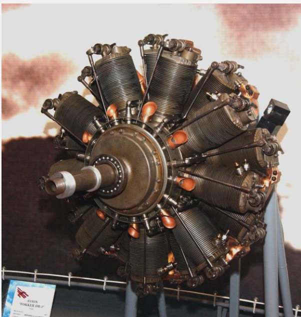
Moteur Gnome & Rhône 340 ch 18-cyl rotatif d'origine Le Rhône. (Musée Snecma).
