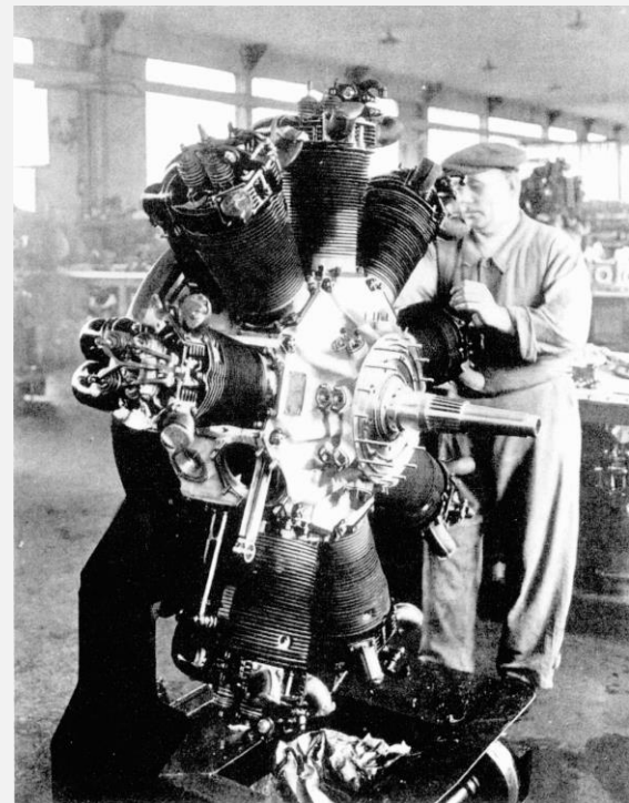
Montage des moteurs Jupiter à l'usine Kellermann en 1929. (Snecma-Moteurs).
