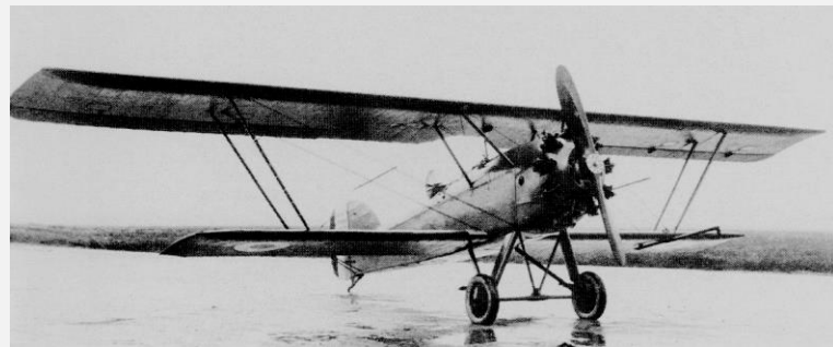
Potez 25.3 (prototype du Potez 25) à moteur Jupiter de 420 ch (1925). (Les Ailes).
