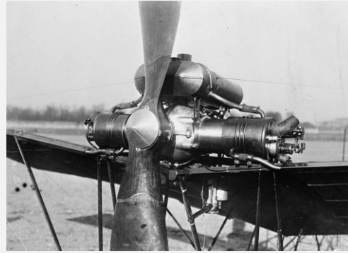
Le moteur flat-twin 10 ch d'origine Le Rhône produit par Gnome & Rhône pour le concours des moto-aviettes (1921). (Sneema-Moteurs).
