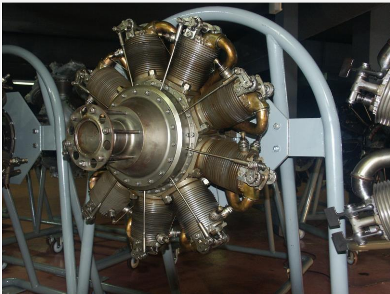
Moteur Gnome & Rhône 9Z, d'origine Le Rhône, 1920. (MAE, cliché de l'auteur).
