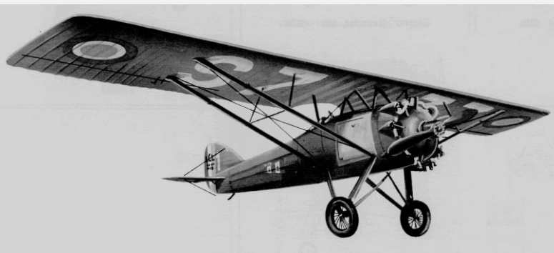
Le Gourdou-Leseurre GL-32 possède une aile haute parasol type Morane-Saulnier. Equipé d'un Jupiter de 420 ch, cet appareil décrocha en 1929 le record national roumain d'altitude. (Encyclopédie Alpha).
