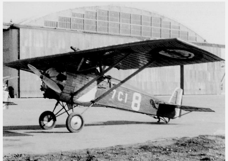
Dix-huit Wibault 74 à moteur Jupiter de 420 ch sont utilisés par la Marine française en 1931. (Cliché Musée de l'Air).
