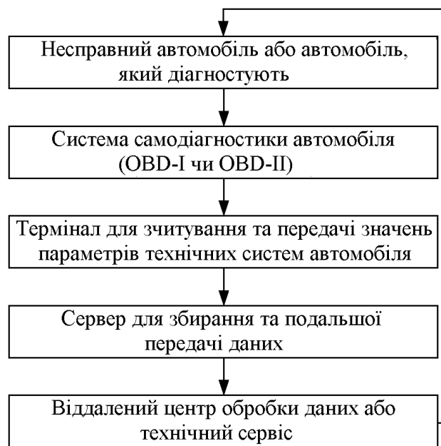
Рис. 2.1. Схема взаємодії елементів сервісу дистанційних сервісних послуг та діагностування автомобілів
