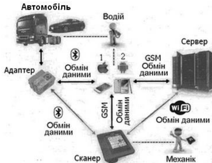
Рис. 3.1. Дистанційна комп'ютерна діагностика автомобіля:
