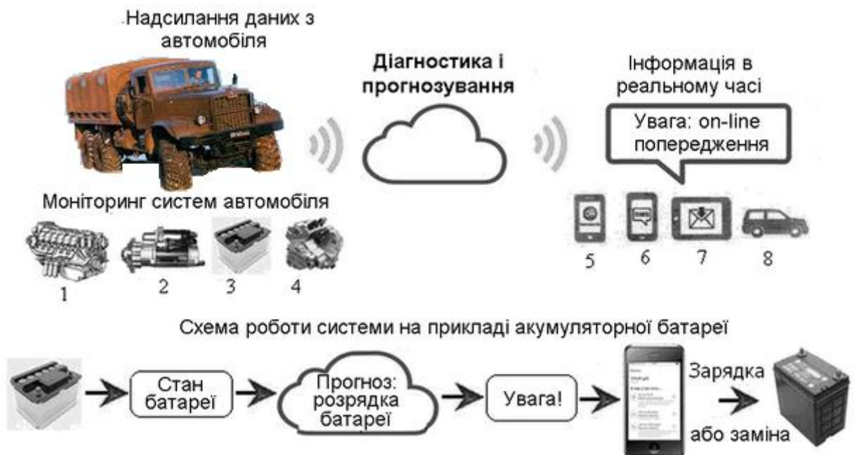
Рис. 3.3. Технологія Proactive Alerts для діагностування та прогнозування технічного стану:
