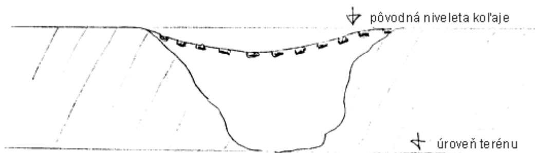
Obr. 6.6b Úplná prietrž násypu zemného telesa (pozdĺžny rez)
