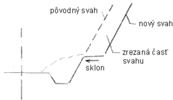
Obr. 6.11c Svah zárezu obnovený zrezaním a úpravou svahu
