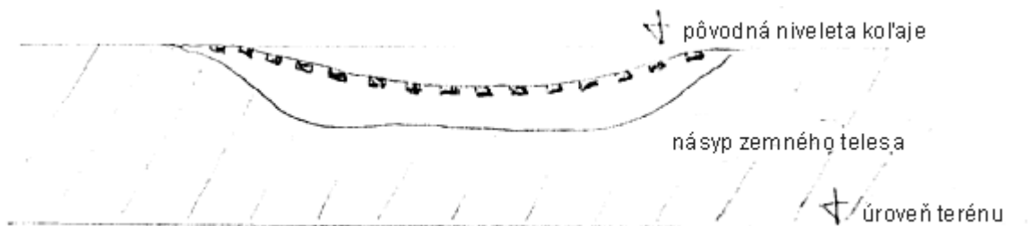
Obr. 6.6a Čiastočný prieval násypu zemného telesa (pozdĺžny rez)
