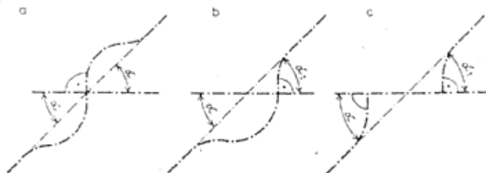
Obr. 3.31 Úprava šikmých úrovňových priesečných križovatiek (a,b), resp. s odsadenými odbočnými pruhmi (c)
