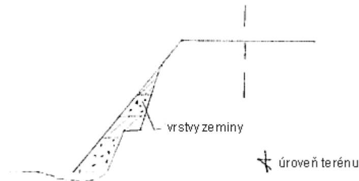
Obr. 6.11b Podomletý svah násypu obnovený po vrstvách
