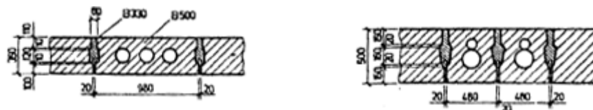
Obr. 4.64a Priečný rez nosnej konštrukcie z nosníkov ŽMP-62
