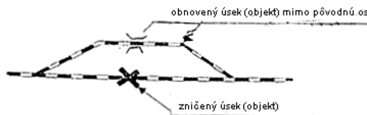
Obr. 7.1 Obnova zničeného úseku železničnej trate mimo pôvodnú os
