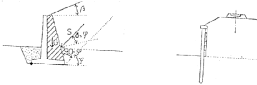
Obr. 2.57 Uhlová a pilótová stena
