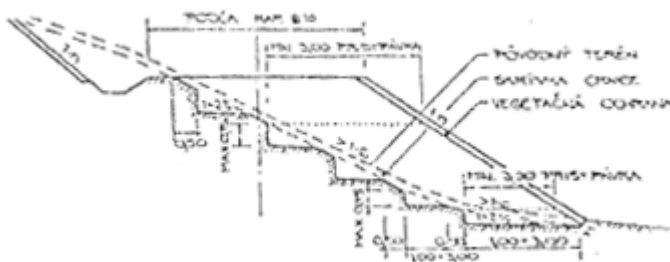
Obr. 2.43 Svahové stupne v podloží násypu
