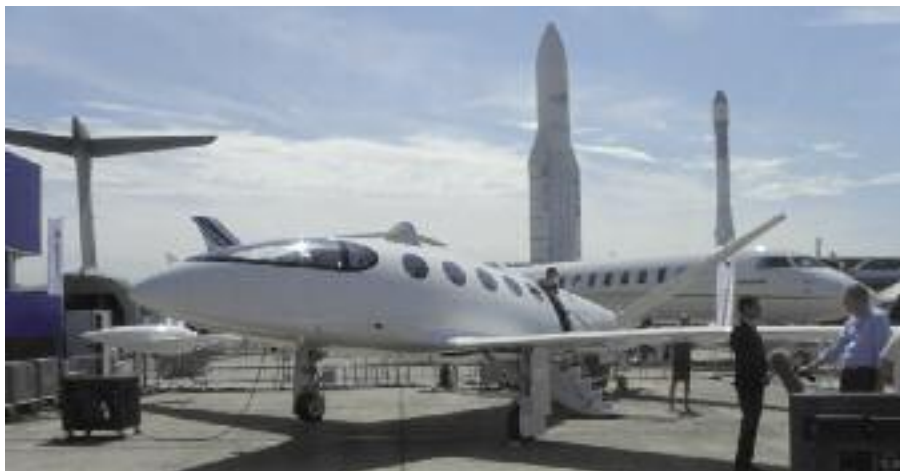
L'inconsueto Alice è un trimotore elettrico dalle linee filanti, che il costruttore Eviation dichiara di voler mettere in servizio nel 2022.
