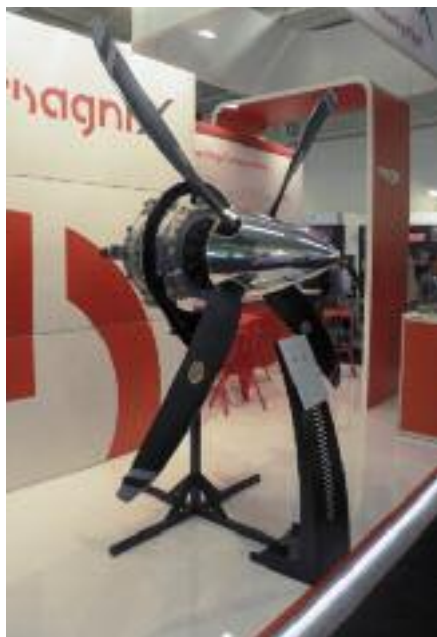
Ciascuno dei tre motori Magnix fornirà all'Alice 375 HP di potenza, ma richiede anche quasi 1.300 chili di batterie.
