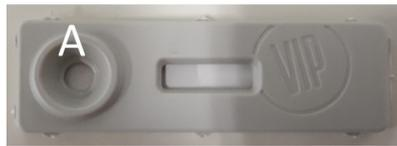
**Figura 8:** Dispositivo de teste VIP Gold Listeria. A-Poço de adição da amostra.
