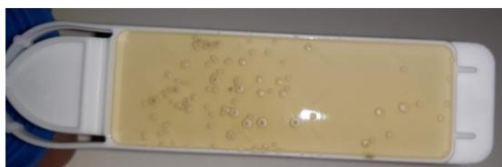
**Figura 20:** *Dipslide* com meio Agar que permite o crescimento de espécies aeróbicas.
