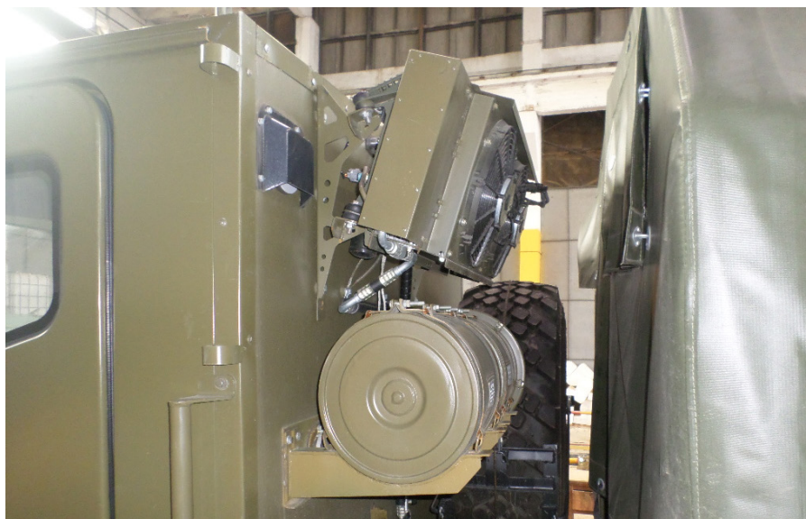
Рис. 9. Блок фильтровентиляционной установки и оборудование системы кондиционирования
