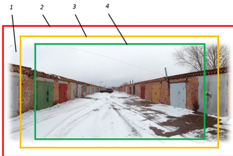
Рис. 2. Границы охвата поля зрения оптическими линзами прибора наблюдения с телевизионным каналом
