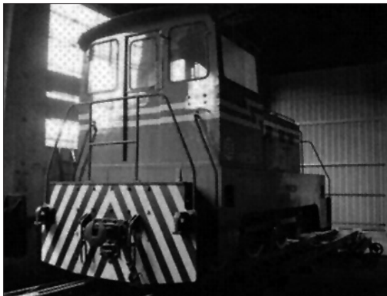
Tractor de maniobras construido por NAVAL motor Rolls- Royce (Patrimonio A.C.A.F.)
