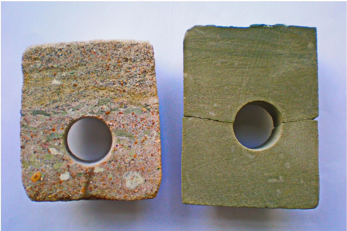
Рис. 2.3 Св. 901-Шебелинська. Ліворуч - T_{1sr1} , пісковик пухкий, різнозернистий, на глинисто-карбонатному цементі. з прошарками гравійного конгломерату, складеного кременем, вапняком і глиною. Керн 4, інт. 660-666 м. Праворуч - T_{1dr}^{cor} , пісковик дрібнозернистий на глинистому цементі. Керн 5, інт. 706-715 м
