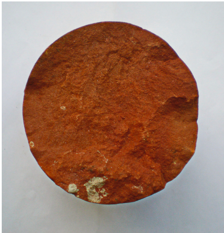
Рис. 2.1 T_{idr}^{per} , пісковик тонкозернистий на карбонатному і карбонатно-глинистому цементі. Св. 900-Шебелинська. Керн 14, інт. 1038-1046 м
