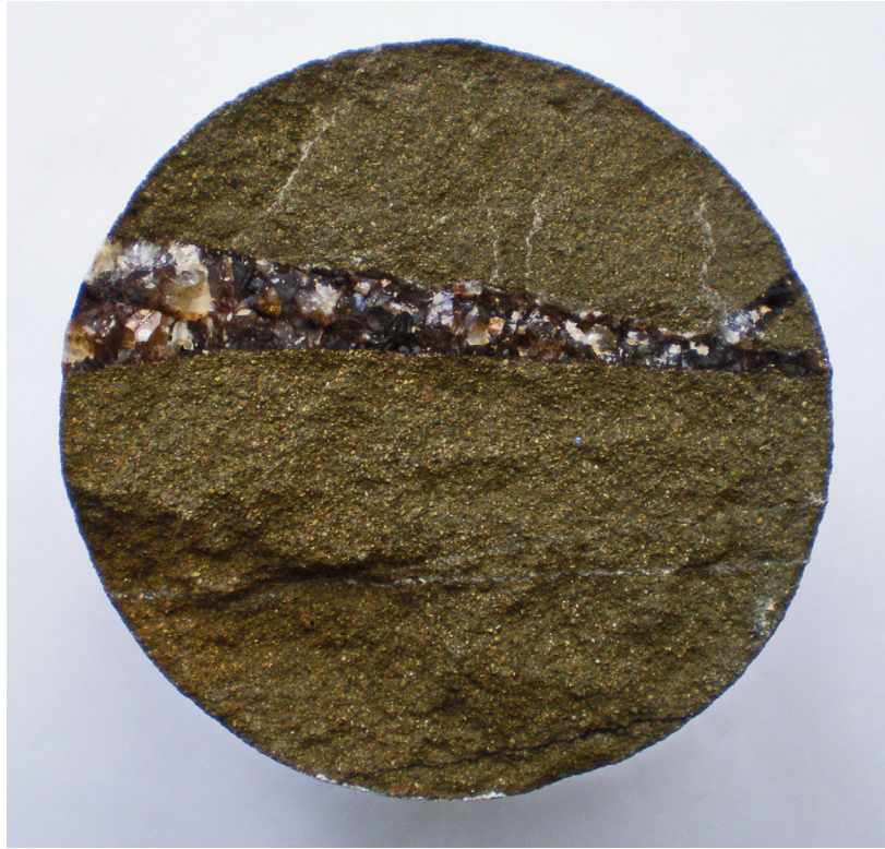
Рис. 2.11 J 2 bt. Пісковик туфогенний, глинистий, різнозернистий, кальцітизовні тріщини заповнені бітумом. Св. Бригадирівська-10. Керн 3, інт. 330-338 м
