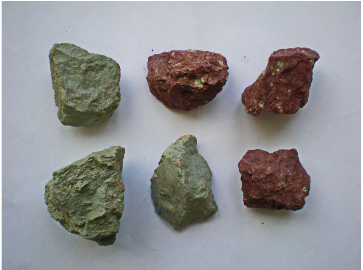
Рис. 2.20 T 2sr2 . Глини плямисті з дрібними карбонатними стяжіннями. Св. 900-Шебелинська. Керн 3, інт. 632-639 м
