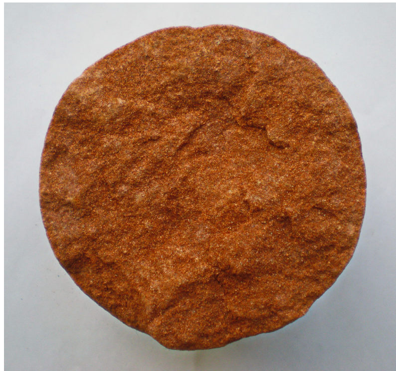
Рис. 2.2 T_{1dr}^{shb} , пісковик тонко-дрібно-середньозернистий на карбонатно-глинистому цементі. Св. 900-Шебелинська. Керн 13, інт.980-985 м
