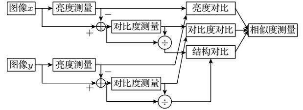
图3 SSIM 评价算法框架
