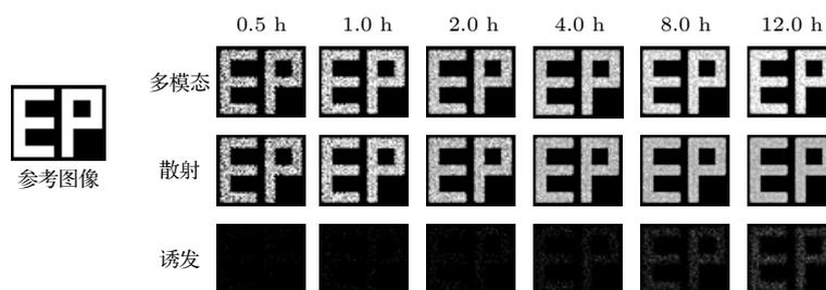
图 13 参考图像和 3 种成像方法成像灰度图
