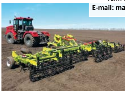
Культиватор модульный прицепной «Антарес» КМП-14 в агрегате с трактором К-744РЗ в работе
