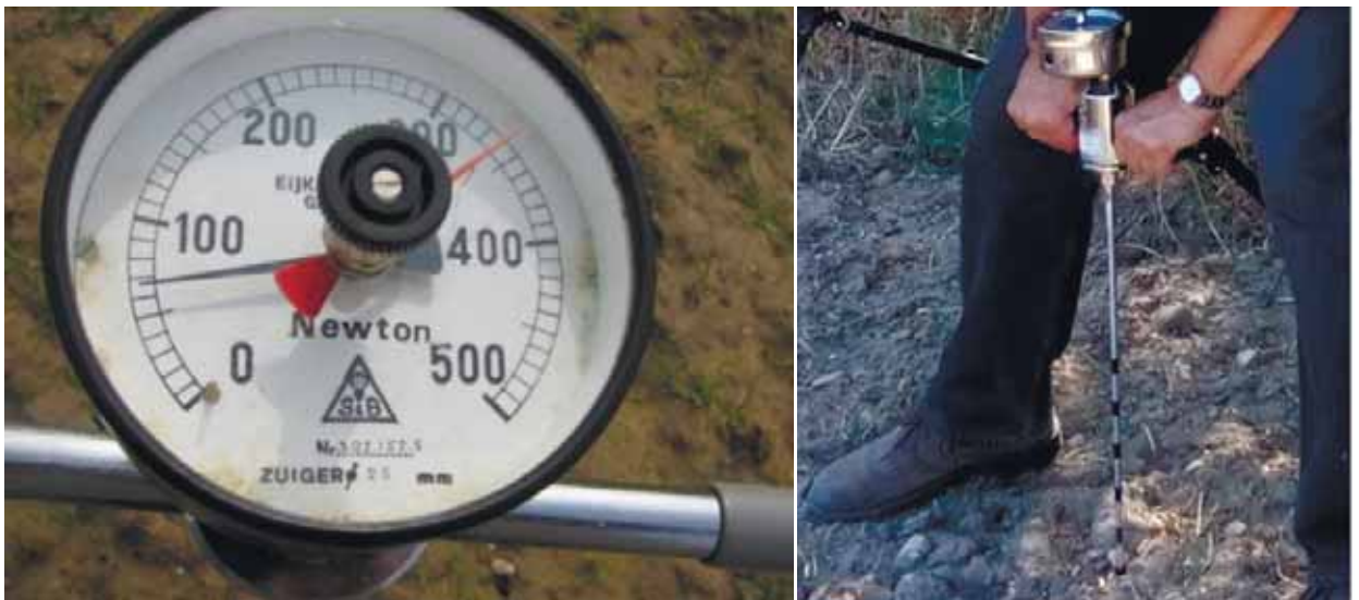
Рисунок 3.16 – Определение усилия пенетрации на контрольных сечениях орошаемого участка, поливная норма 500 \text{ м}^3/\text{га}
