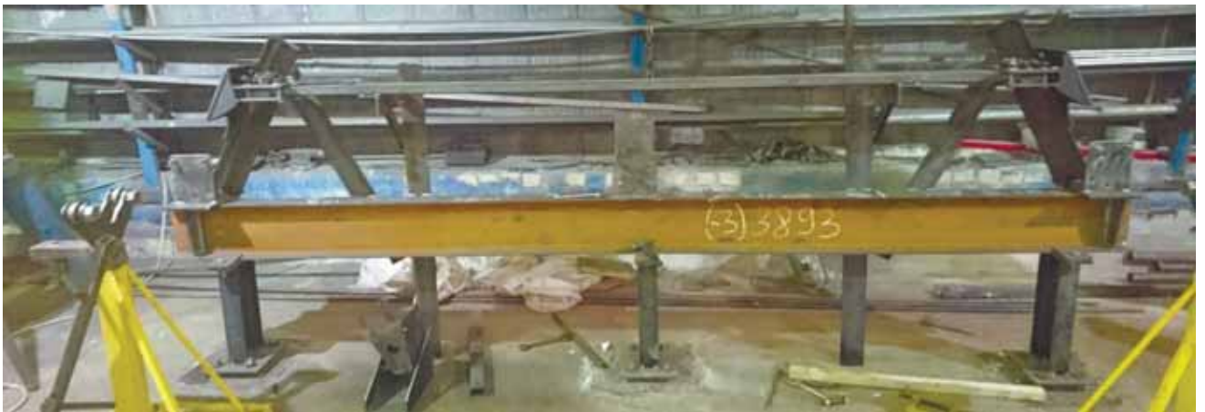
Рисунок 3.7 – Экспериментальная установка для изготовления и подбора конструктивных размеров ходовой тележки
