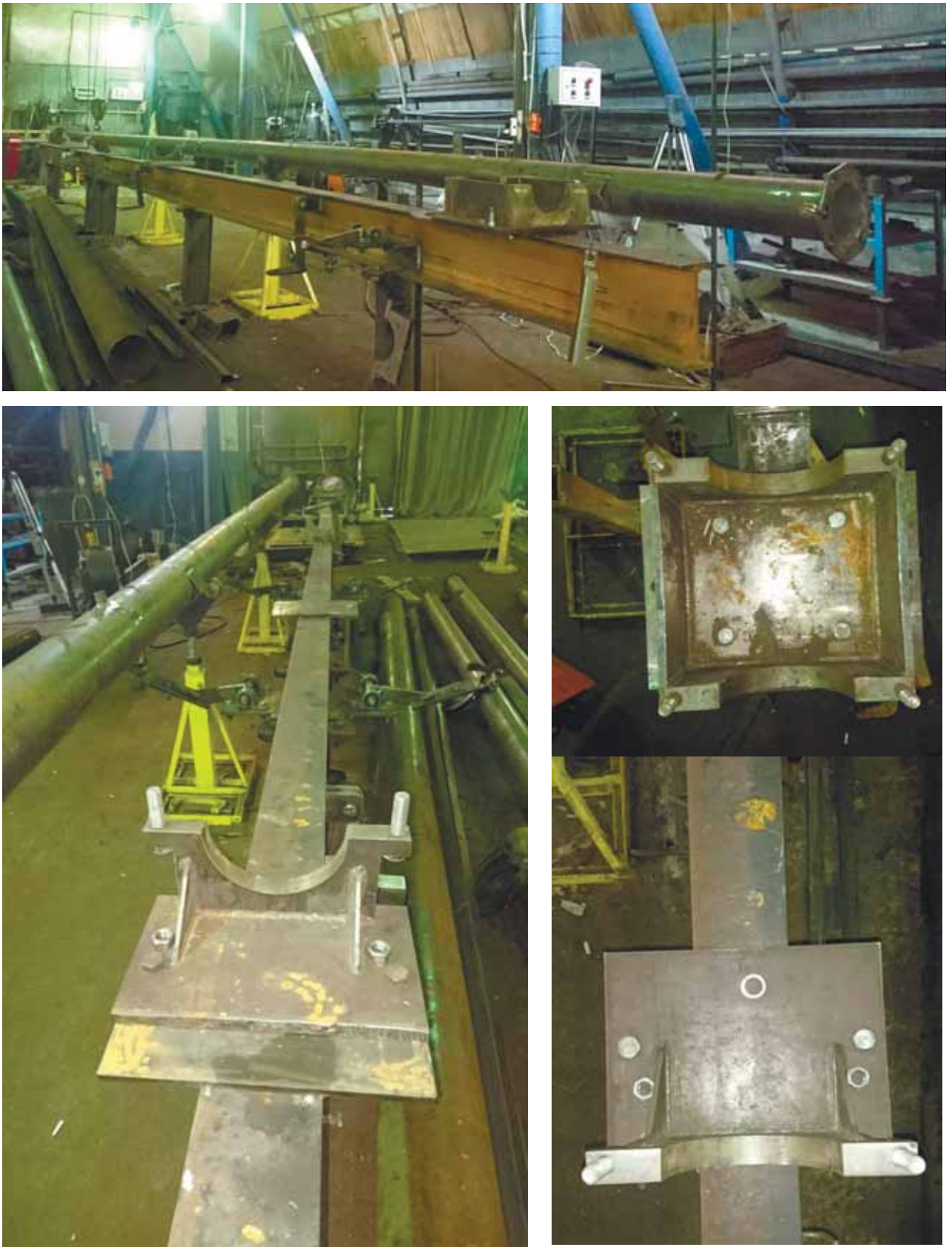
Рисунок 3.9 – Экспериментальная установка для изготовления и подбора конструктивных размеров водопроводящего трубопровода
