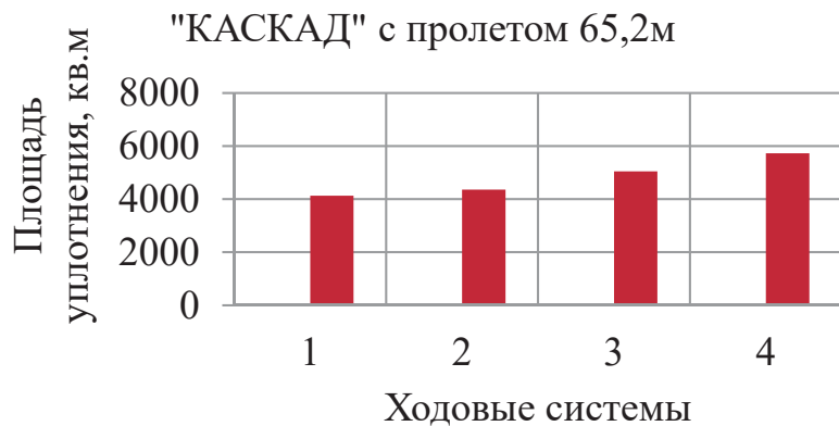
Рисунок 2.51 – Площадь уплотнения в зависимости от длины пролета для ходовых систем с шинами: 1 –14,9-24; 2 –15,5-38; 3 –16,9-24; 4 –18,4-26
