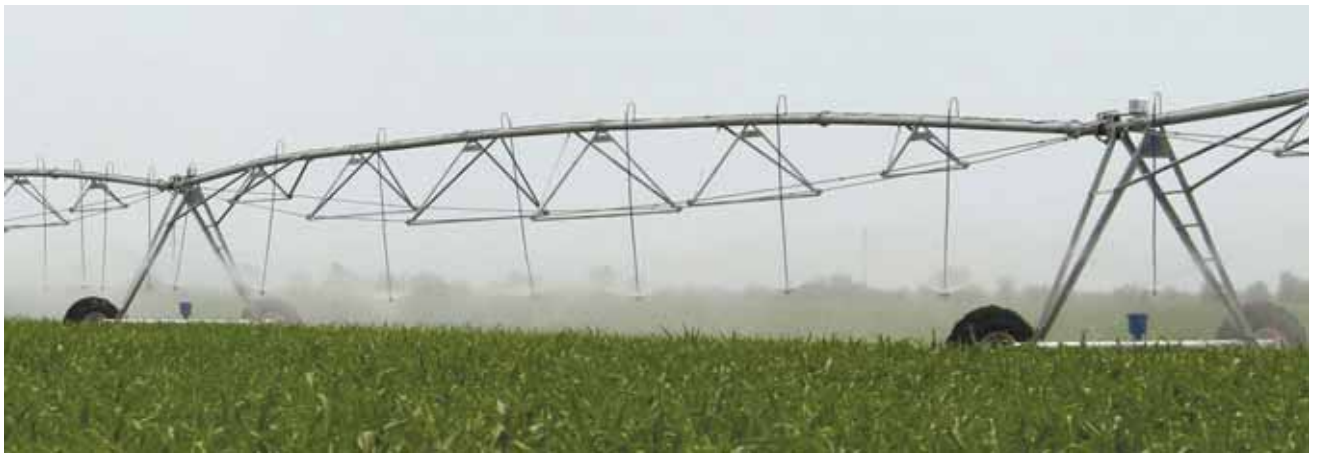
Рисунок 2.43 – Ферменная конструкция «Кубань-ЛК-1М» с длиной пролета 48,7м
