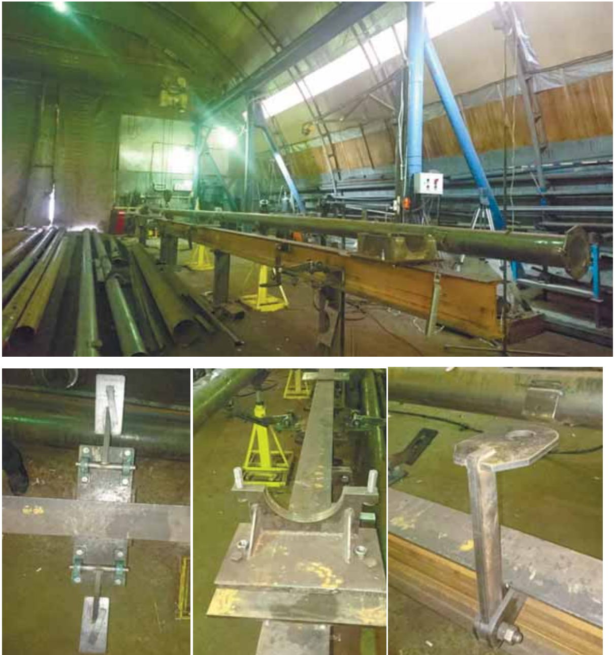
Рисунок 2.5 – Кондуктор изготовления водопроводящего трубопровода
