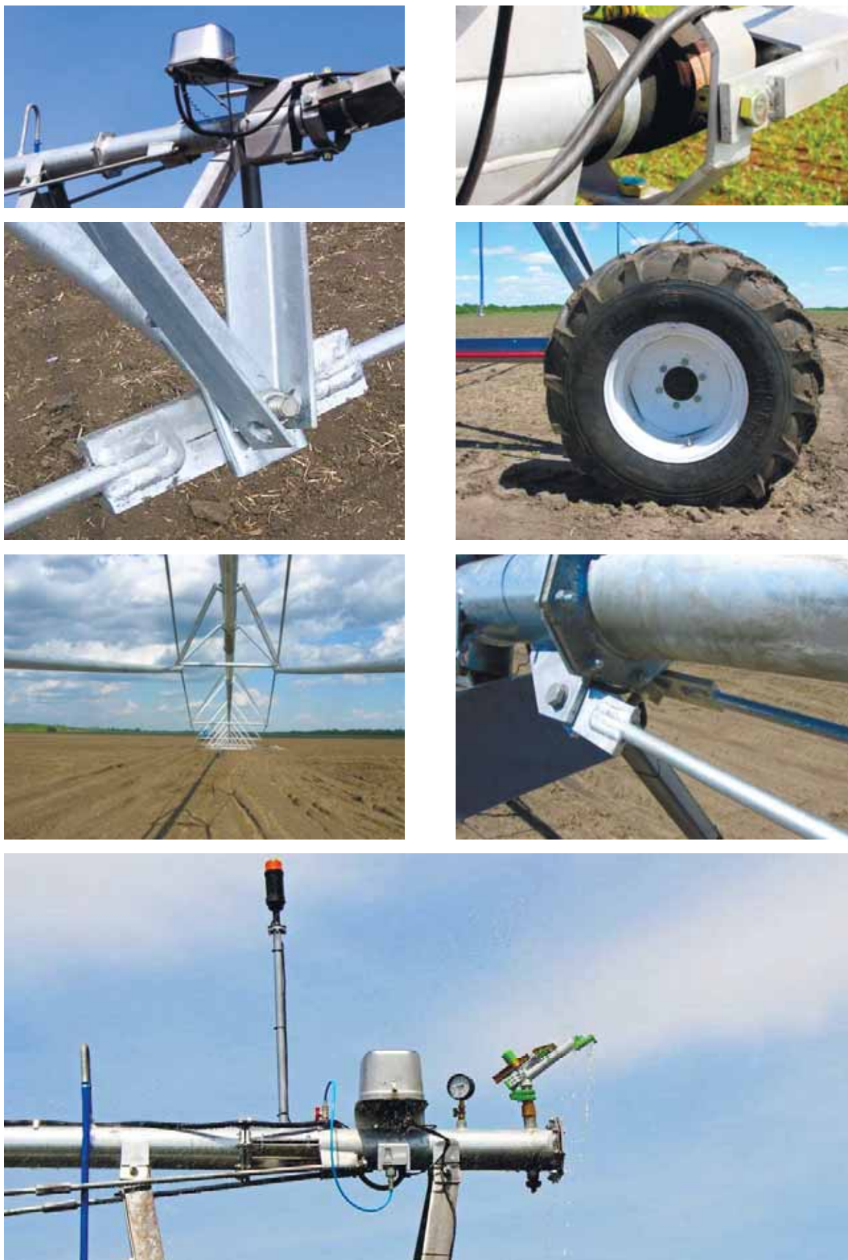
Рисунок 2.4 – Элементы конструкции «Кубань-ЛК1М» (КАСКАД)
