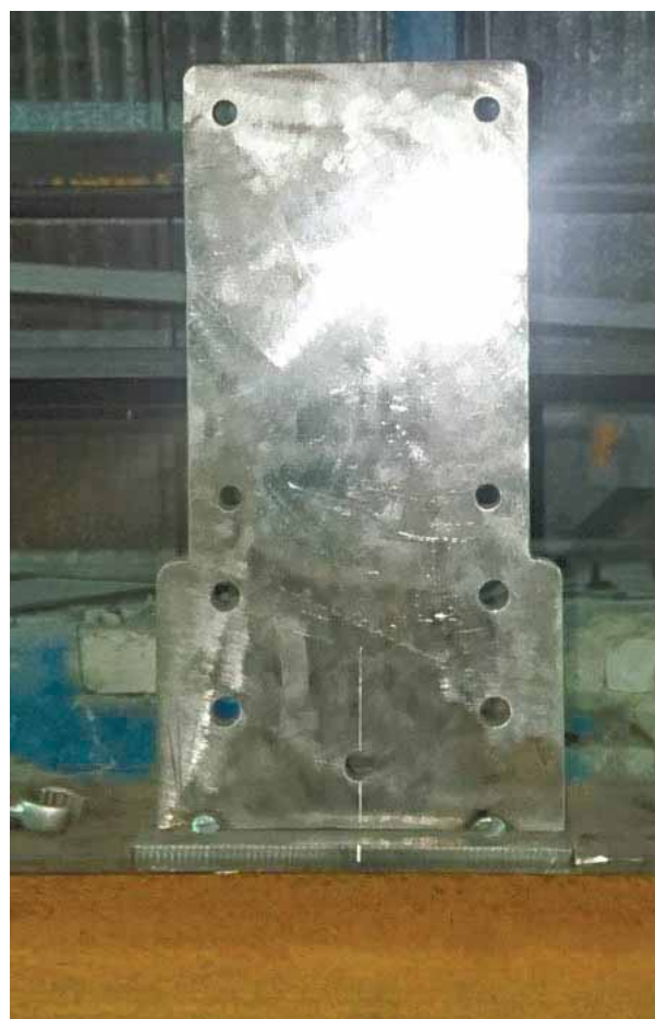
Рисунок 2.6 – Кондуктор изготовления опорных тележек
