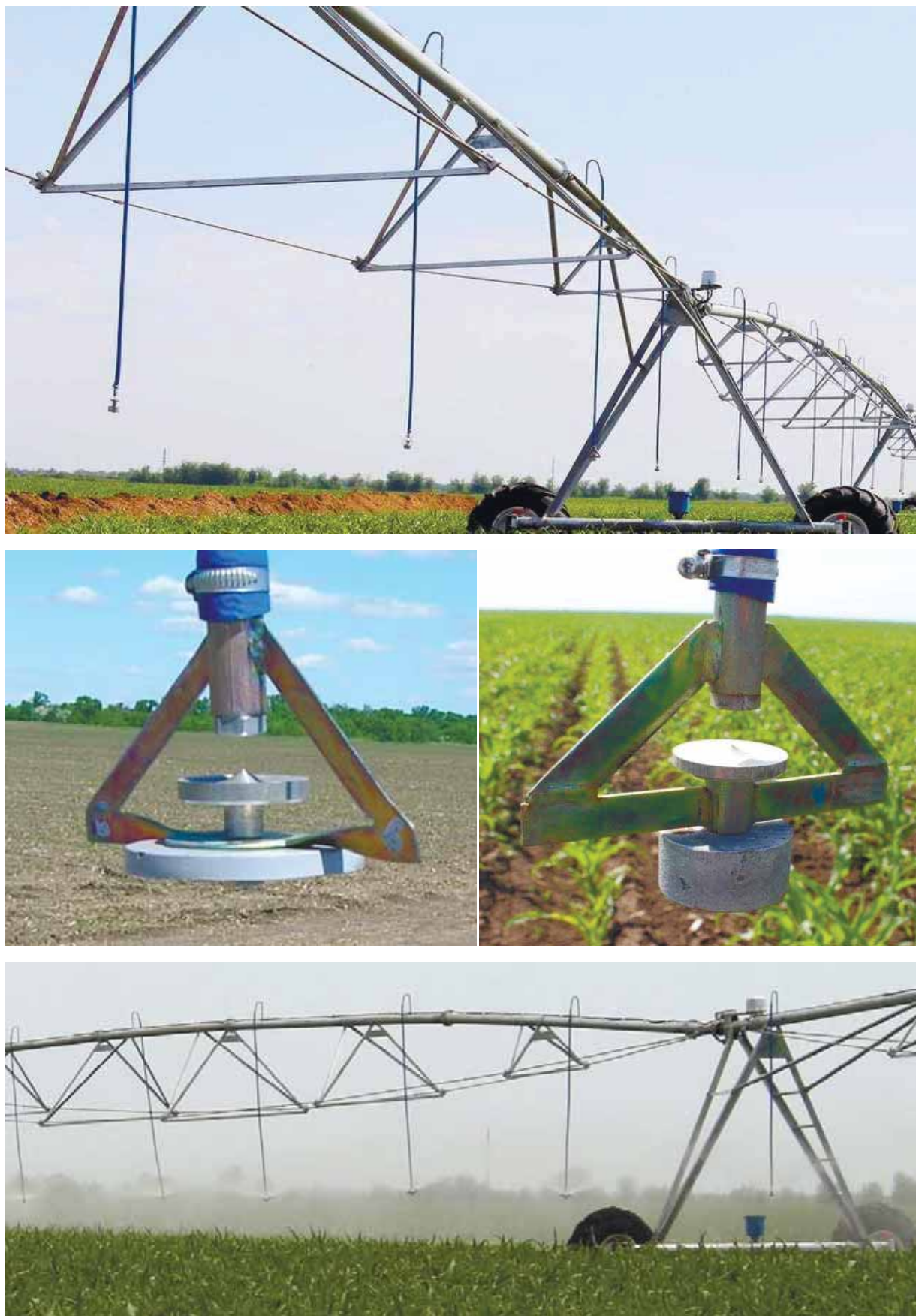
Рисунок 5.3 – ДМ «Кубань-ЛК1М» (КАСКАД). Ферменная система 1. Пролет 48,7м
