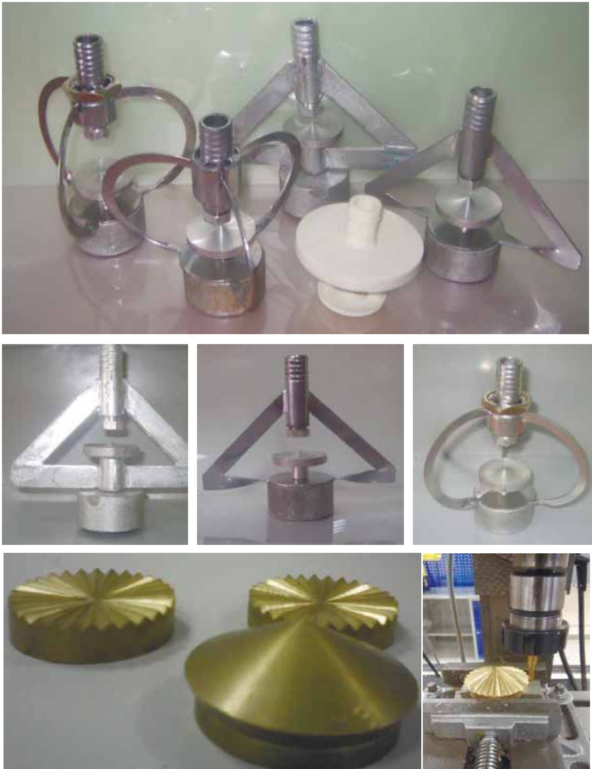
Рисунок 2.29 – Дождеватель из оцинкованной стали типа 1, сменные deflectоры разной геометрии
