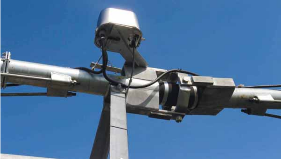
Рисунок 3.19 – Приборы синхронизации движения в линию промежуточных тележек
