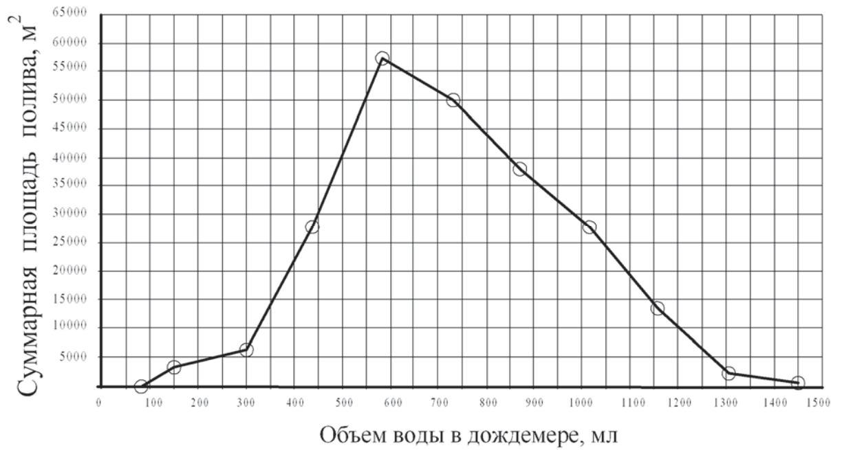
Рисунок 1 – Частотный график распределения объема воды в дождемерах вдоль трубопровода ДМ «Фрегат» K_{ЭП} = 0,73 ; K_{НП} = 0,12 ; K_{ИЗП} = 0,14 , скорость ветра 5м/с
