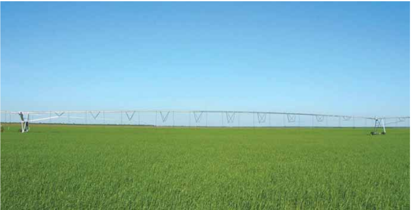
Рисунок 5.5 – ДМ «КАСКАД». Ферменная система 2. Пролет 65,25м.
