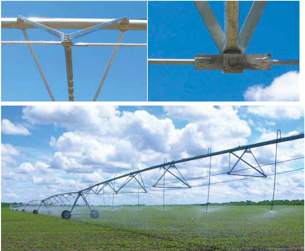
Рисунок 2.44 – Ферменная конструкция ДМ «КАСКАД» с длиной пролета 59,5м
