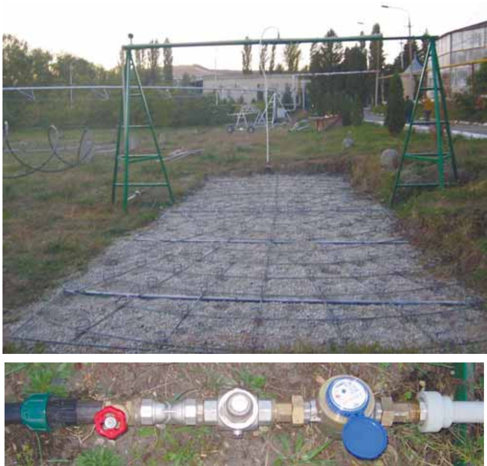
Рисунок 3.2 – Стенд для испытаний дождевателей
