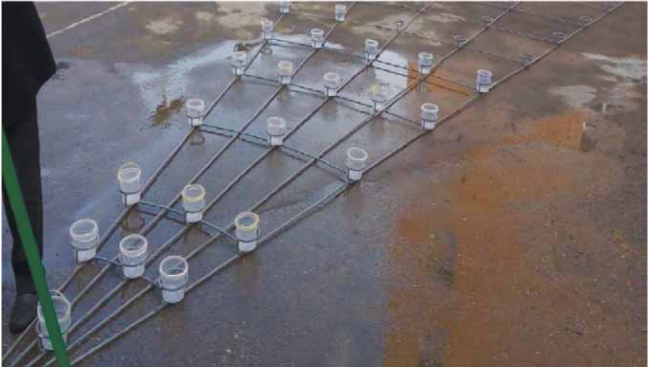
Рисунок. 3.14 – Расстановка дождемеров при лабораторных исследованиях
