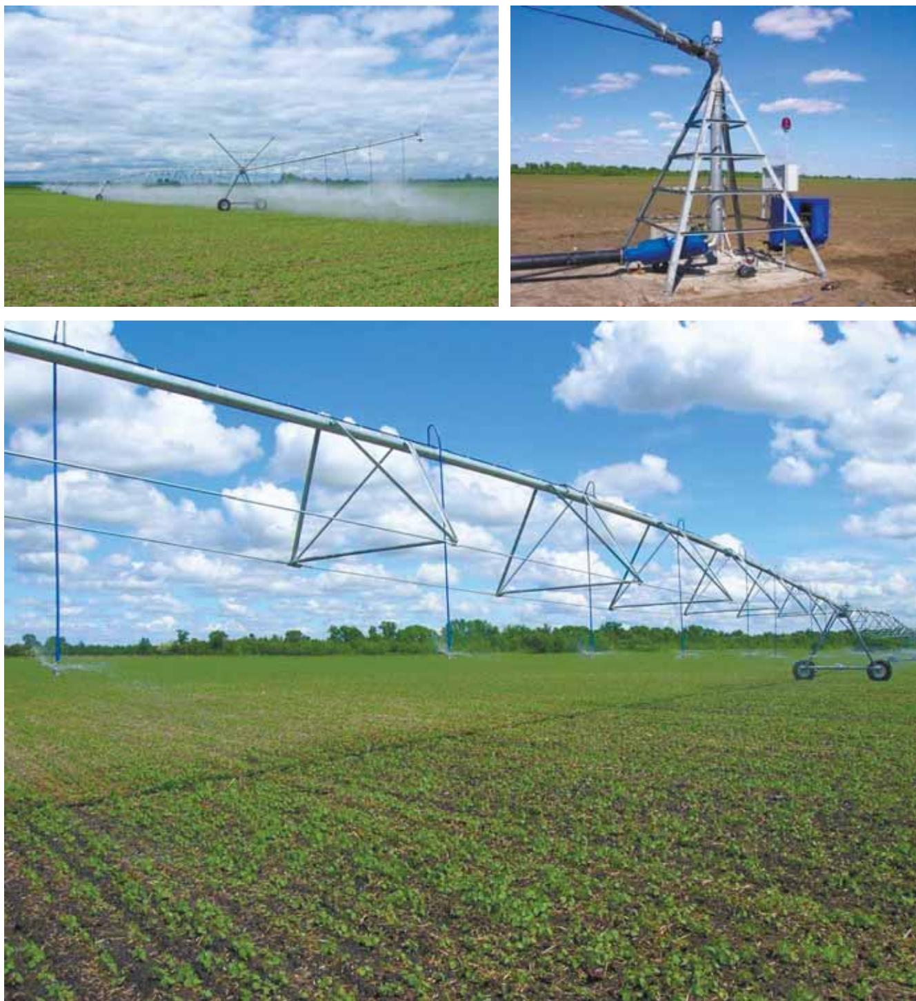
Рисунок 2.9 – Дождевальная машина КАСКАД в работе
