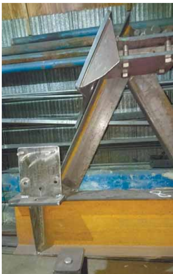
Рисунок 2.6 – Кондуктор изготовления опорных тележек
