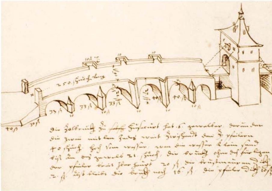
« Le pont douanier de ~~Soteh~~ Husacurt [Voujeaucourt] a 6 voûtes. Les deux voûtes centrales ont une largeur de 40 pieds entre les piles. Lorsque les eaux sont basses, il y a 21 pieds de hauteur de la surface de l'eau jusqu'à la voûte. Le pont a sans les avancées des piles une largeur totale de 20 pieds. Le parapet étant épais de 2 pieds, il reste encore 16 pieds pour le pont. Les piles ont une épaisseur de 10 pieds »
