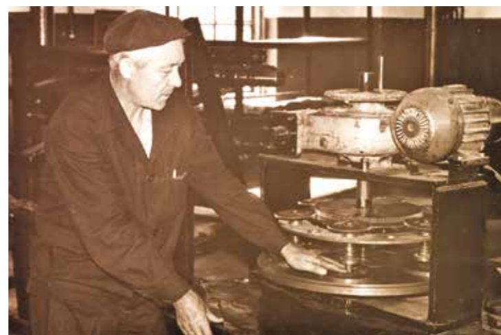
А. В. Назаров, слесарь АРНУ, выполняет работу на станке по притирке торцевых уплотнительных колец, 1970 год
