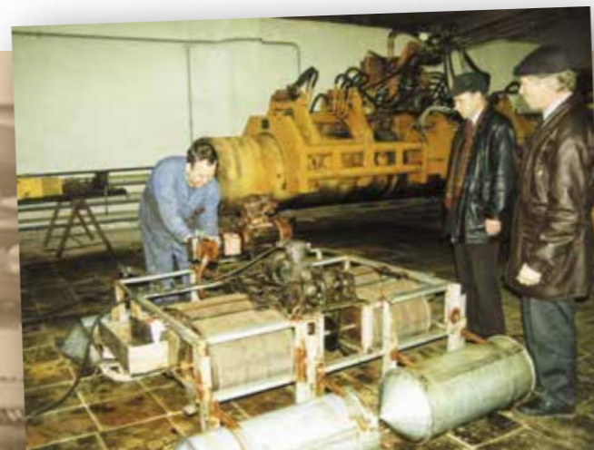
Слесарь-наладчик ЦБПО Г. В. Белоклоков за наладкой нефтесборщика, 1997 год
