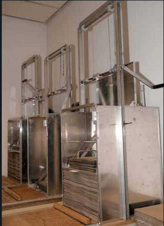
Die Trawöger-Thermostatpressen bei der Arbeit: während des Pressvorgangs strömt kontinuierlich warme Luft durch die Pflanzenstapel
