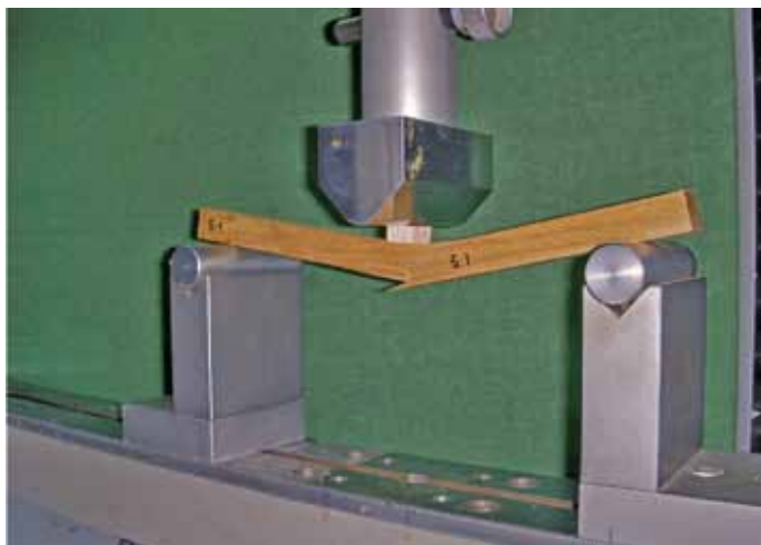
Figura 6. Ensayo de flexión
