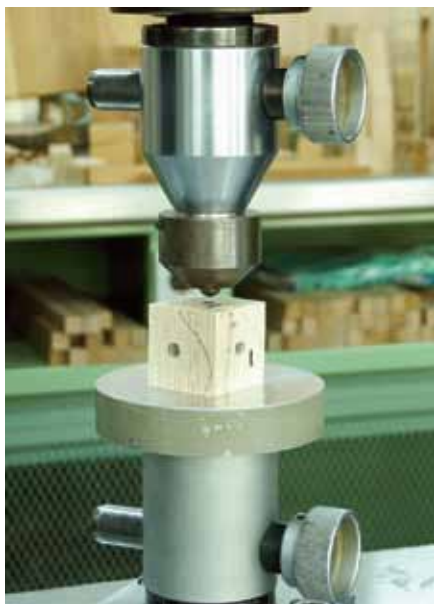
Figura 9. Ensayo de dureza BRINELL
