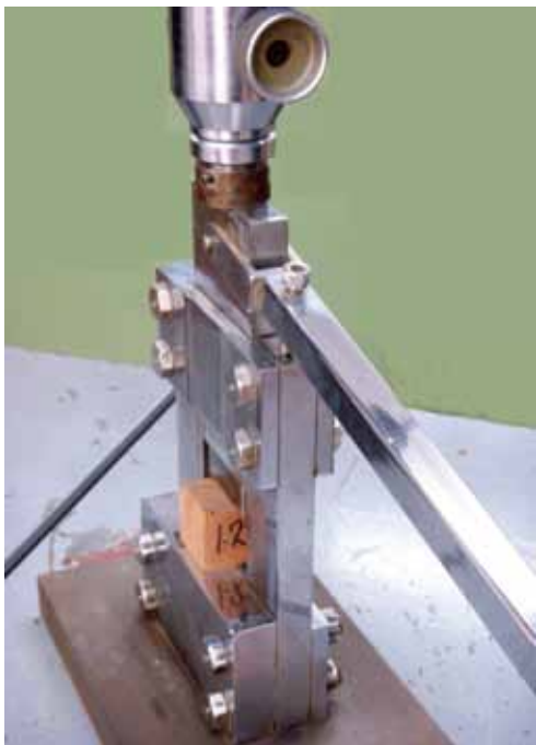
Figura 8. Ensayo de cizallamiento (corte)
