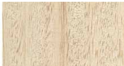
Figura 1b. Zonas con trazos de los vasos largos (cortados en paralelo al hilo) alternando con zonas con trazos de los vasos cortos (cortados a un ángulo), por ejemplo en Parota ( Enterolobium cyclocarpum )
