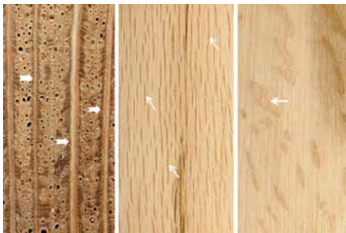
Figura 15. Radios excesivamente grandes de la madera de un encino ( Quercus durifolia ) con su característica apariencia en las secciones transversal (aumento aprox. 12x), tangencial y radial (tamaño natural).
