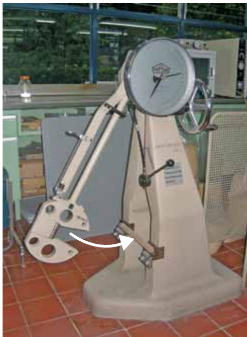
Figura 7. Ensayo resistencia al impacto (péndulo)
