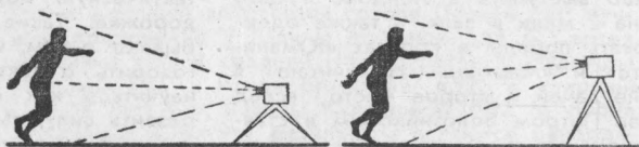
Рис. 1. Установка кинокамеры для съемки нециклических движений: а — правильная, б — неправильная
