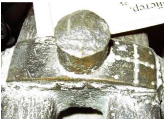
Завершення корони дзвонів вагою 11 п. 18 ф і 9 п. 20 ф. та позначення на більшому й меншому дзвонах
