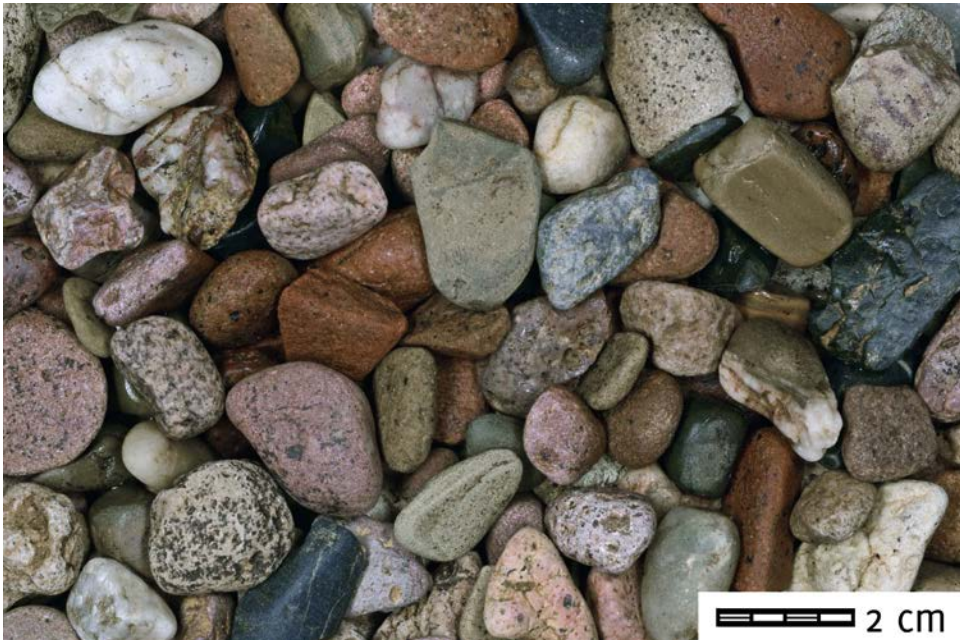
Abb. 5 Kies aus der Weser-Oberterrasse in Kirchrode. Baugrube Großer Hillen 2, Probe GH-1, 1,6 bis 1,9 m unter Gelände (Schichtenverzeichnis im Anhang; Abb. 4), Korngröße 12,5–20 mm. Kennzeichnend für Weser-Material ist der hohe Anteil an rotbraunen und roten Buntsandstein-Geröllen sowie hier rosastichig erscheinenden dunklen und hellen Quarzporphyr-Geröllen aus dem Thüringer Wald (Foto: F.-J. Harms).
