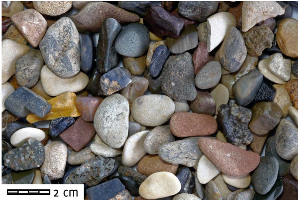
Abb. 2 Kies 12,5–20 mm aus der Niederterrasse des Zooviertels von Hannover. Bohrung Plathnerstraße 27, Probe P27/l, Tiefe 10–11 m unter Gelände. Nur etwa 15 % (Stück-%) der Gerölle bestehen aus hellem Pläner-Kalkstein und Flammenmergel.
