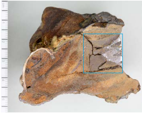
Abb. 4a (oben) Anschliff mit korrodiertem Eisenkern (Rechteck)
