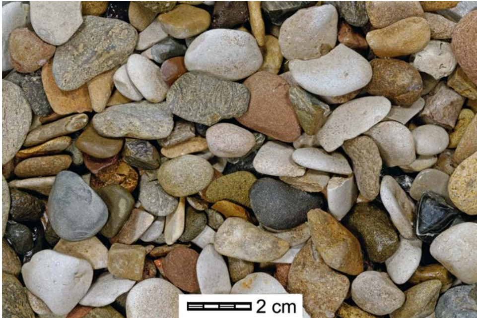
Abb. 3 „Leine-Kies 8–16 mm“ aus dem Holcim-Kieswerk Barnten. Bezogen vom Baustoffzentrum Himmler, Sehnde-Höver, am 9.10.2015 aus Lieferung 29.9.2015. Über 45 % (Stück-%) der Gerölle bestehen aus hellem Pläner-Kalkstein und Flammen-
